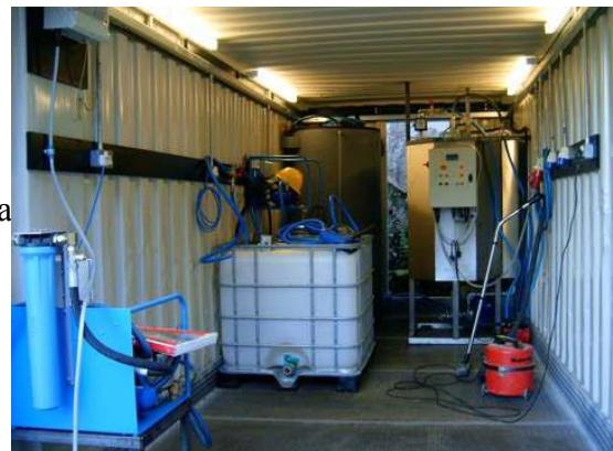
Slika 24: Malo postrojenje za proizvodnju biodizela
