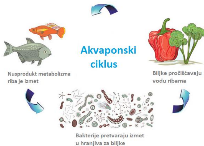
Slika 1. Akvaponski ciklus (Izvor: http://aquaponicpeople.com/ )
