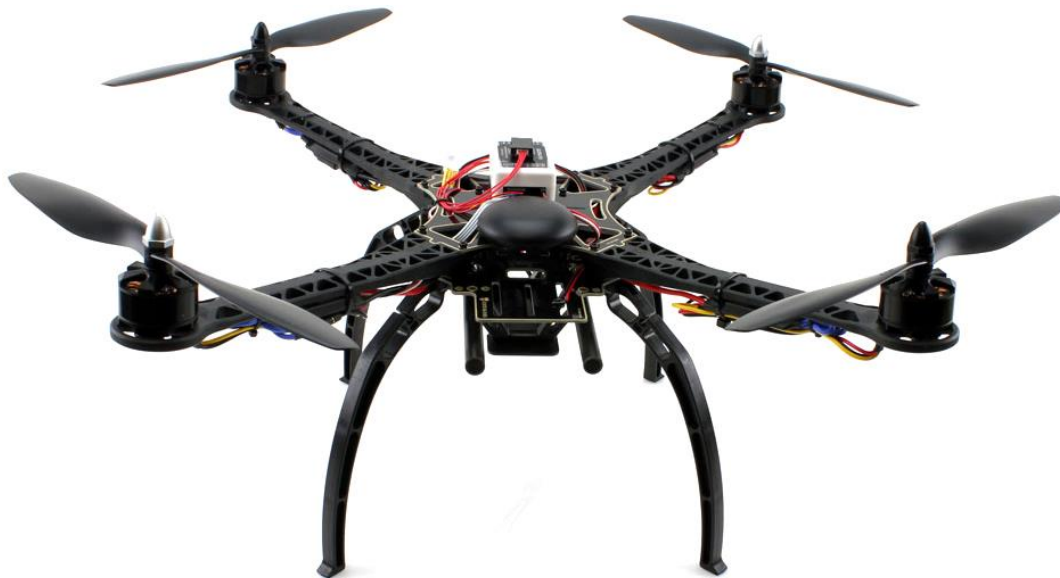
Sl. 13. Model multikoptera sa četiri motora tzv. kvadkopter [28]
