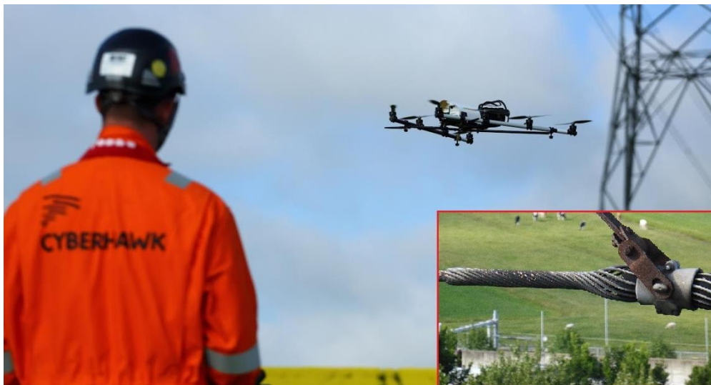
Sl.6. Kontrola dalekovoda bespilotnom letjelicom [12]
