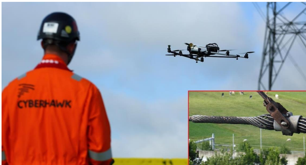
Sl.6. Kontrola dalekovoda bespilotnom letjelicom [12]
