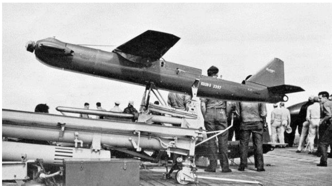
Sl. 1. Bepilotna letjelica KD2R-3 Američke ratne mornarice kontrolirana radio signalom 1954. godine [5]
