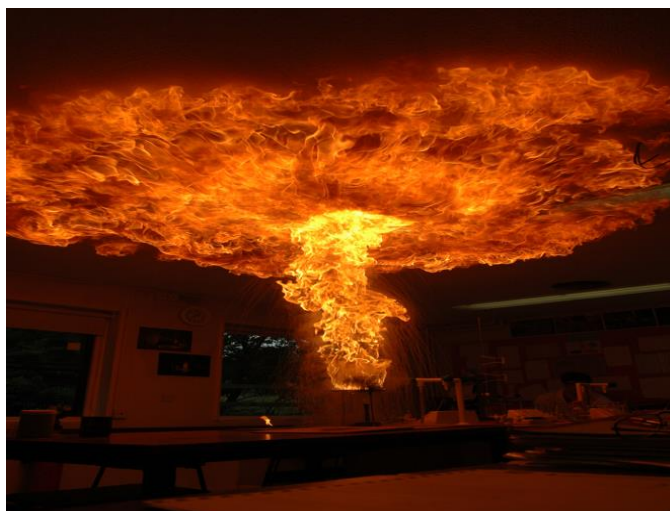
Slika 4. Karakterističan način širenja požara ulja i masti [IZVOR: http://chicagofiredepartment.com/ (15.12.2016.)]
