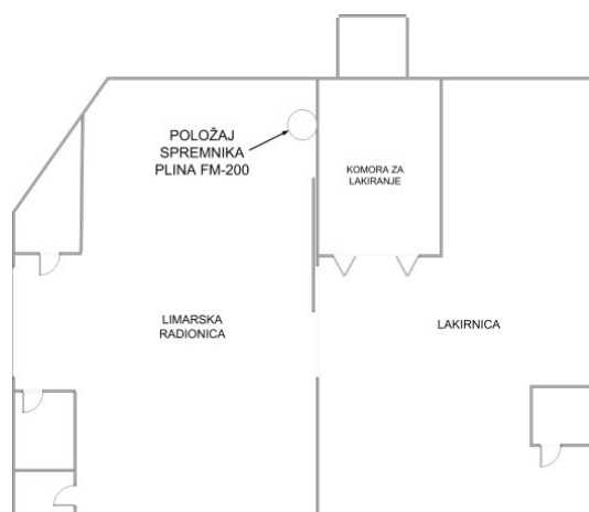
Sl. 37. Prikaz položaja spremnika plina u objektu
