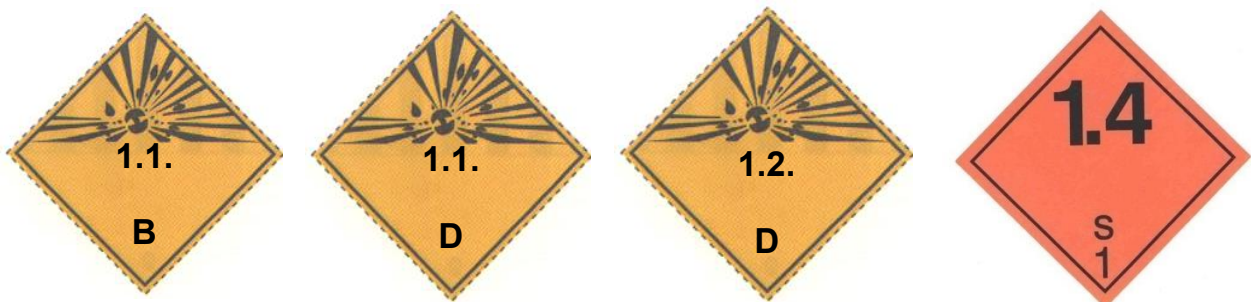
Slika 17. Listice opasnosti za označavanje pakiranja opasnih tvari klase 1 [3]
