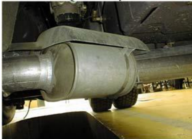
Slika 8. Zaštićeni dijelovi ispušnog sustava [3]
