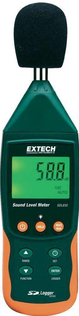
Slika 3.3.Extech SDL600 uređaj za mjerjenje razine zvuka
