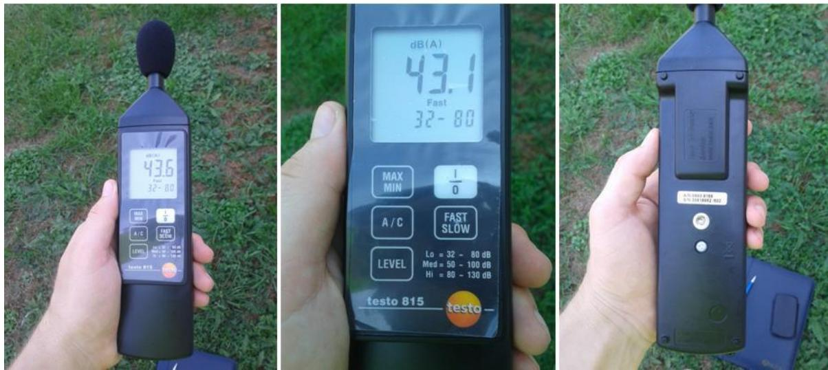
Slika 5.3.Zvukomjer TESTO 815
