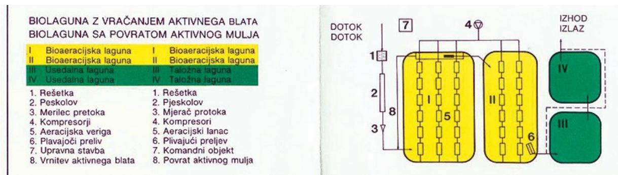
Slika 17. Princip rada Biolagune sa vraćanjem aktivnog mulja[17].
