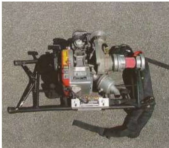
Sl. 8. Prijenosna pumpa FYR PAK [4]
