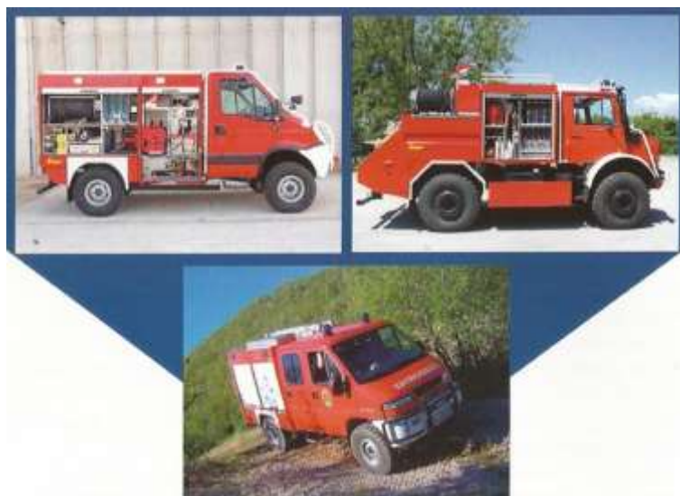
Sl. 7. Vozila za gašenje šumskih požara [4]
