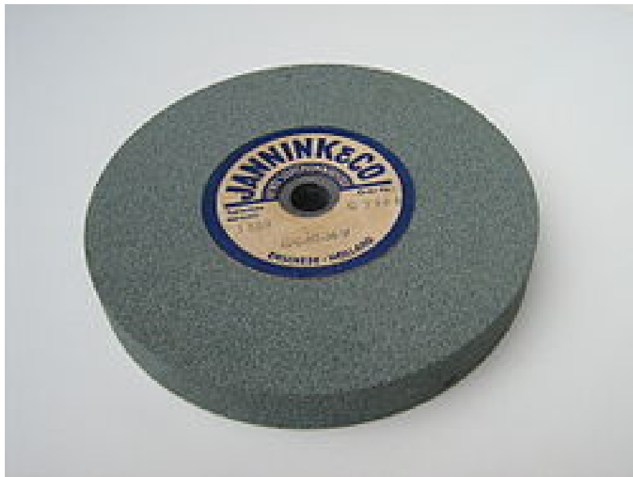
Slika 4.23: Brusna ploča ili brusno kolo koje brusi svojim obodom.
