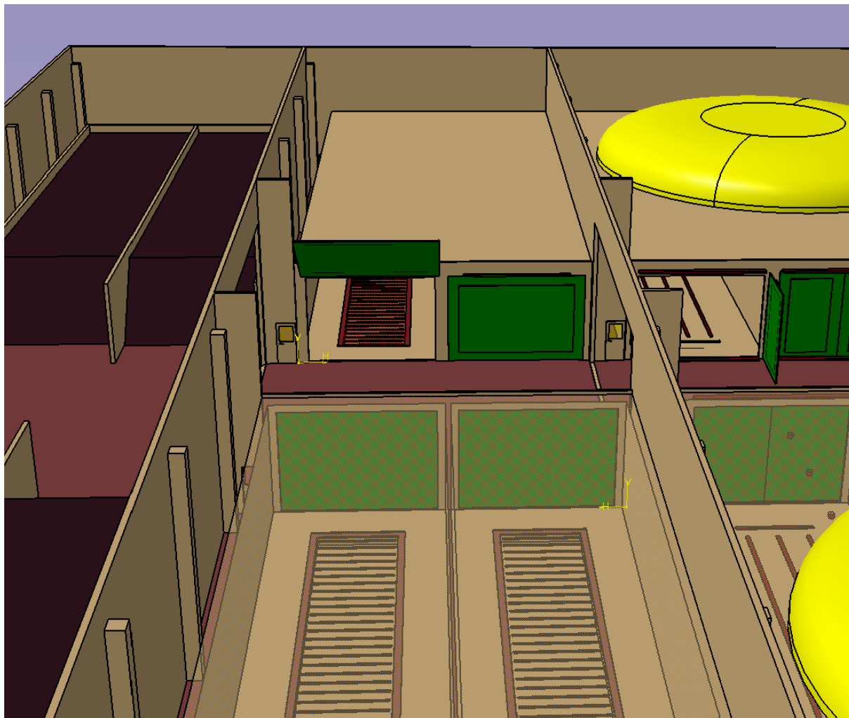
Slika 28. Prikaz tunela za kompostiranje digestata.
