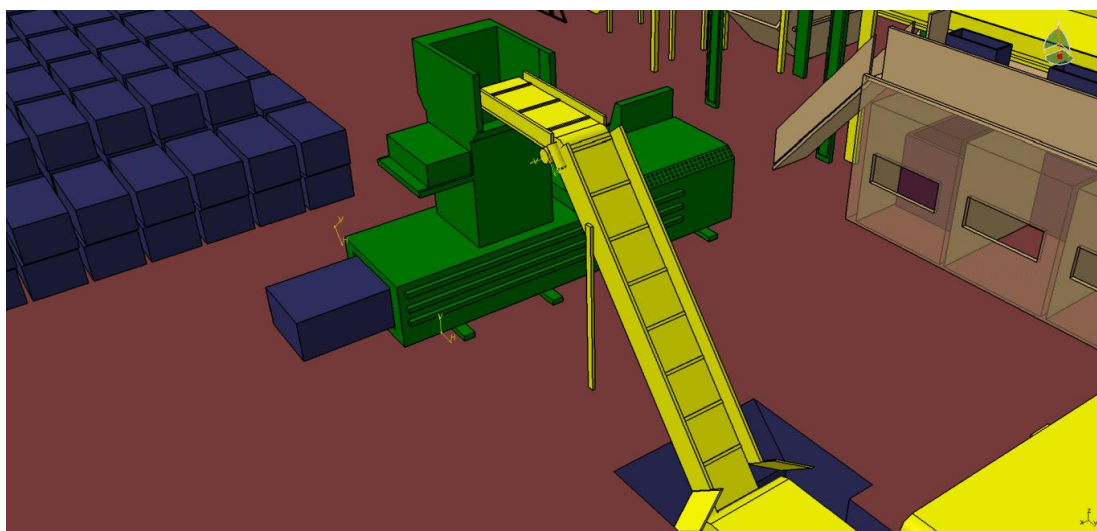
Slika 14. Horizontalna preša balirka s transporterom.
