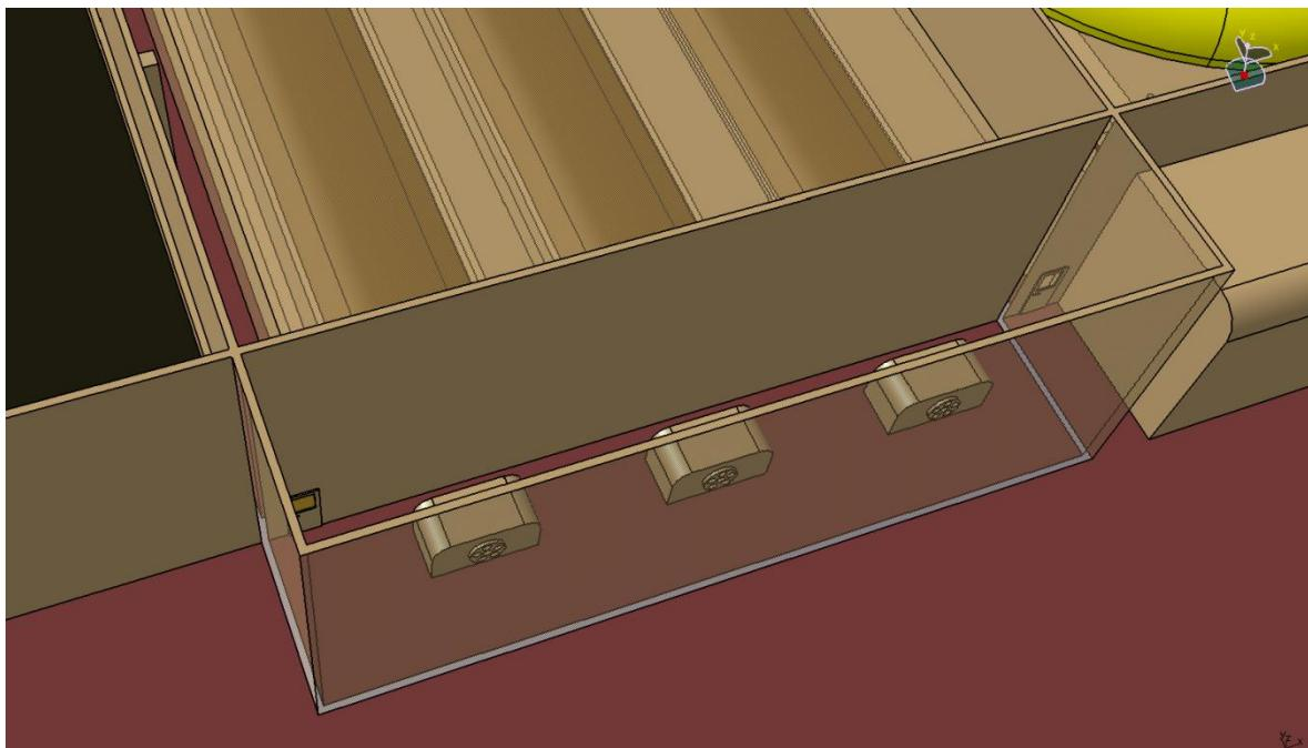
Slika 49. Prikaz ventilacijskog sustava prozračivanja hrpa za biosušenje.
