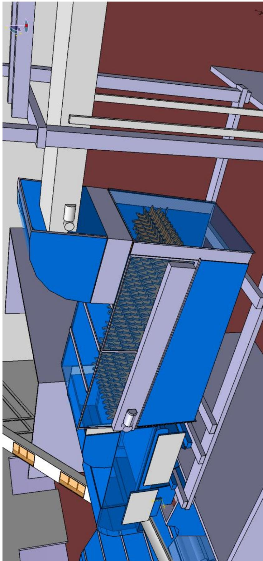
Slika 43. Prikaz zvjezdastog sita za prosijavanje inertnih materijala.
