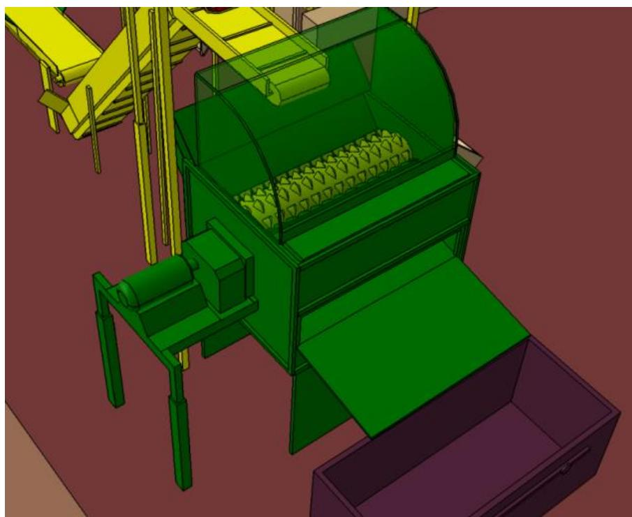
Slika 15. Sekundarni usitnjivač za proizvodnju zamjenskog goriva.
