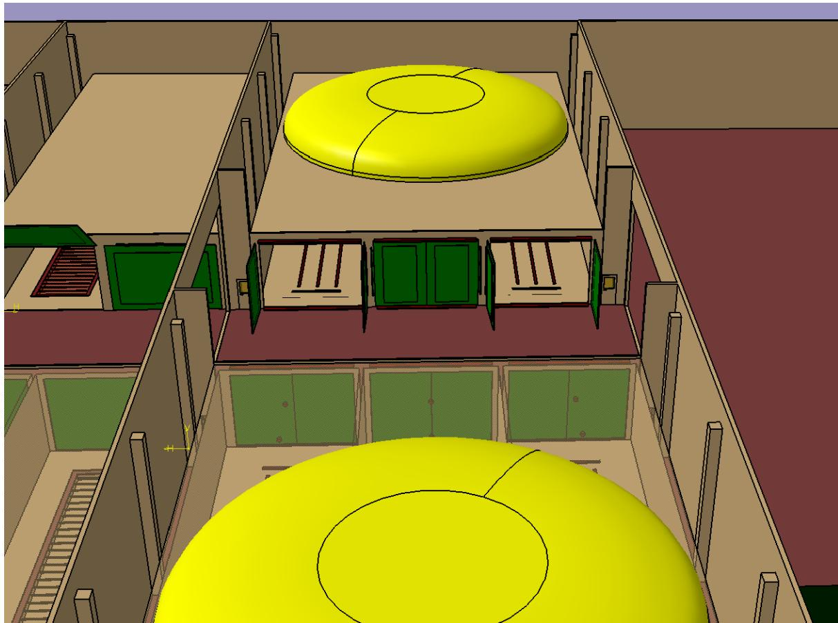
Slika 27. Prikaz suhih fermentera i digestora.
