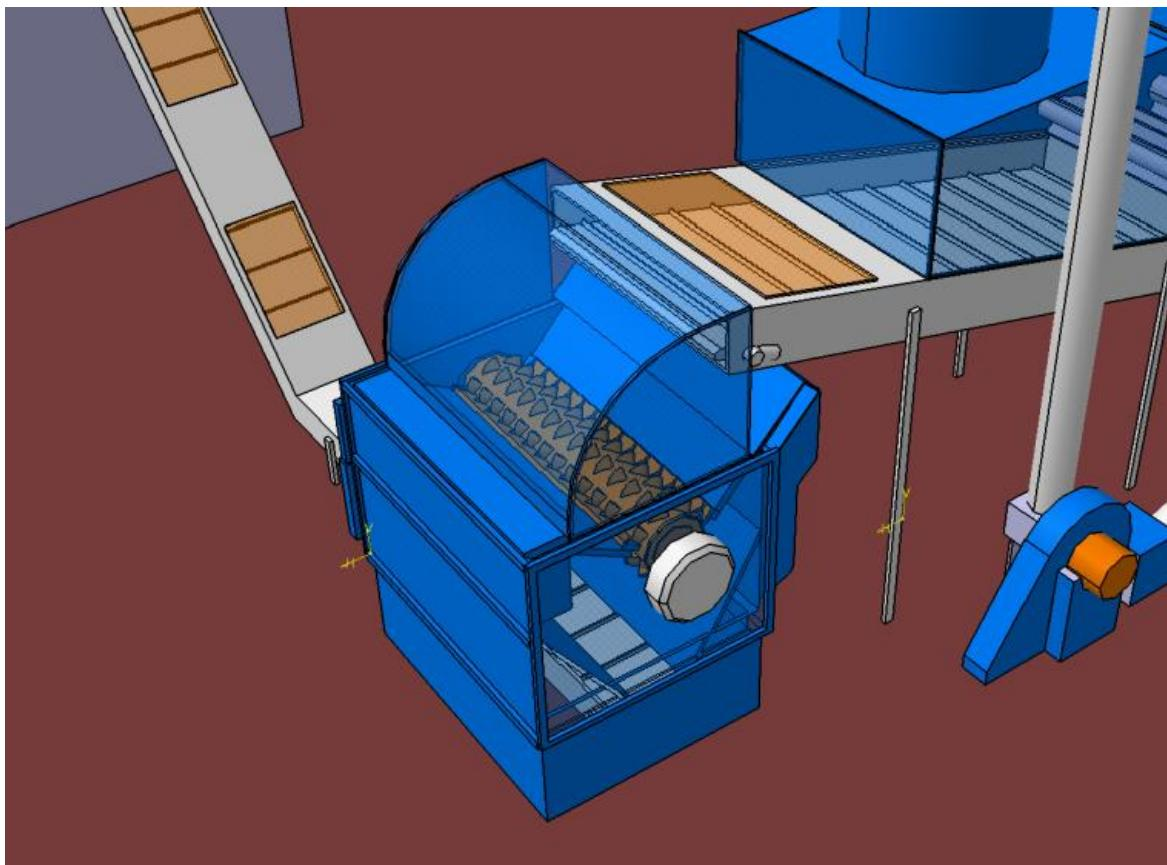
Slika 46. Prikaz finog usitnjivača za granulaciju zamjenskog goriva.
