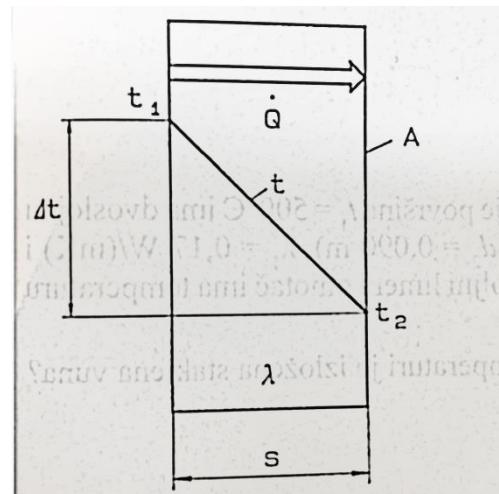
Slika 4. Tok temperature u jednoslojnem zidu [1]
