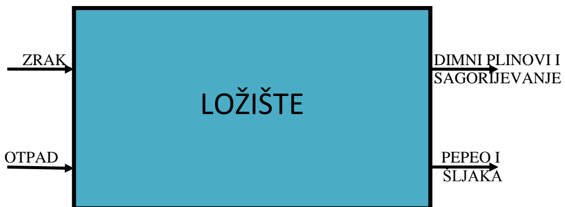
Slika 11. Shema sagorijevanja otpada
