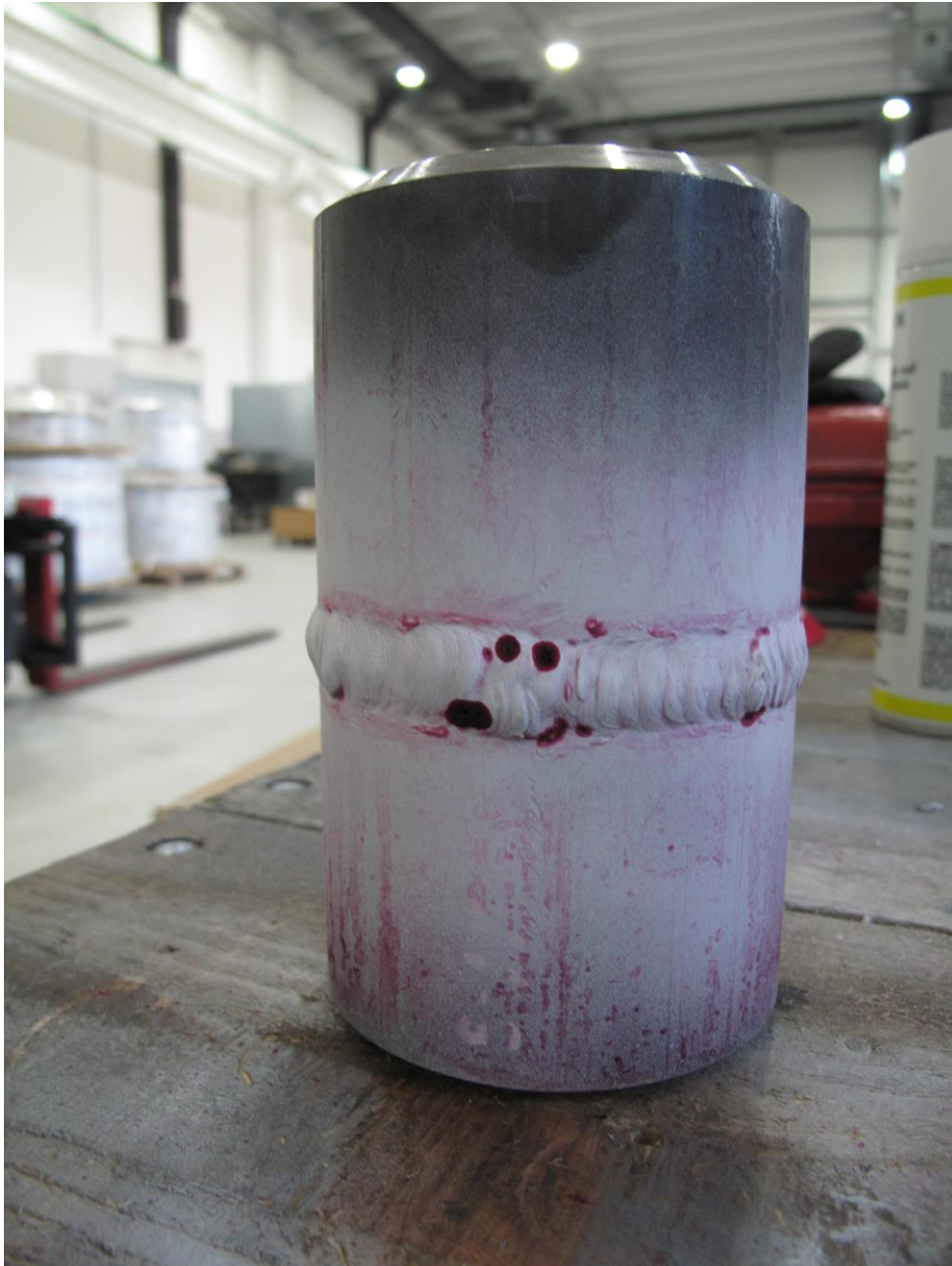
Slika 33. Stvaranje penetrantskih indikacija
