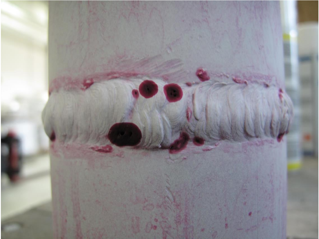
Slika 34. Detektiranje penetrantskih indikacija
