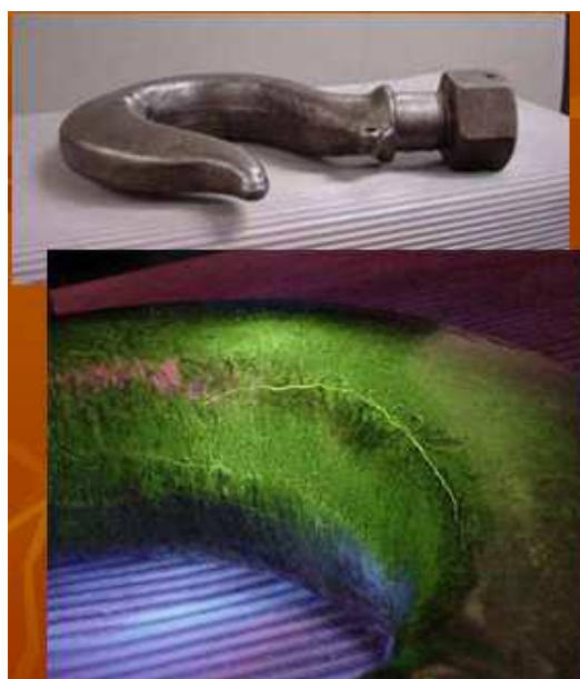
Slika 13. Indikacija pukotine primjenom magnetskih čestica [3]
