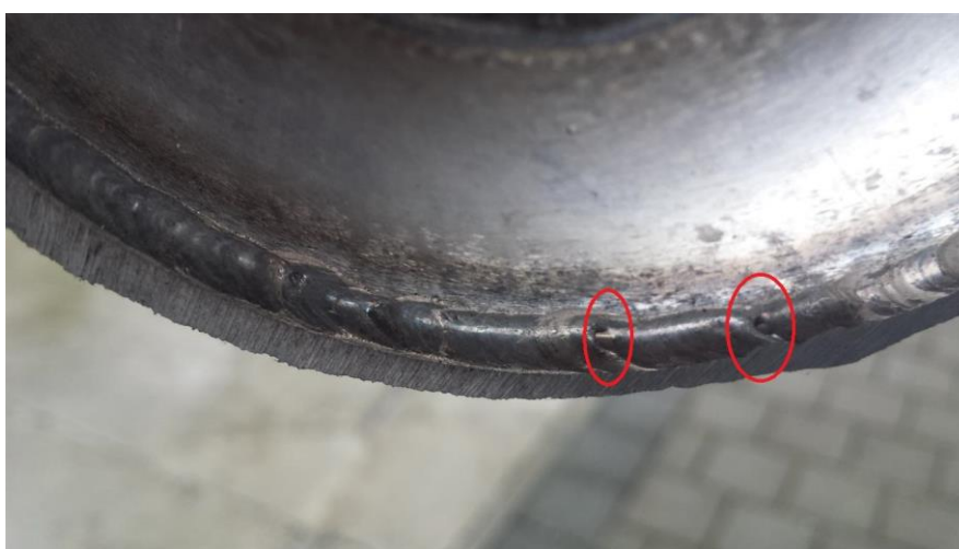
Slika 9. Pore otkrivene vizualnom kontrolom [11]
