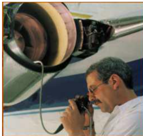
Slika 7. Moderna vizualna kontrola fiberoskopom [3]
