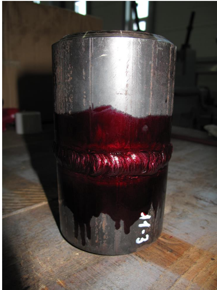
Slika 31. Prikaz nanešenog penetranta na površinu zavora
