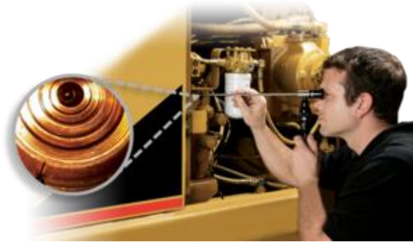
Slika 6. Vizualna kontrola uz pomoć Boreskopa [9]
