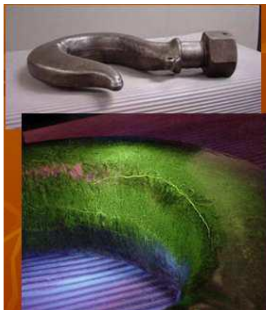
Slika 13. Indikacija pukotine primjenom magnetskih čestica [3]
