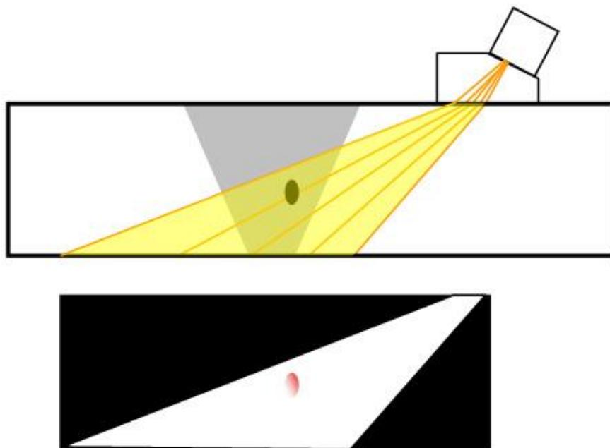
Slika 18. Ultrazvučna kontrola zavarenog spoja [4]
