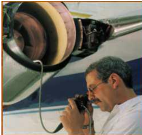
Slika 7. Moderna vizualna kontrola fiberoskopom [3]
