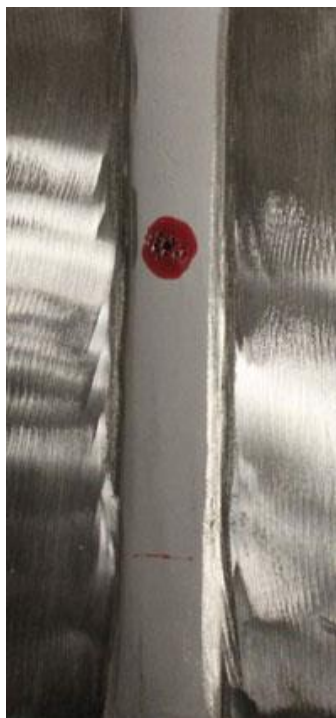
Slika 27. Penetrantska indikacija obojenog penetranta [8]
