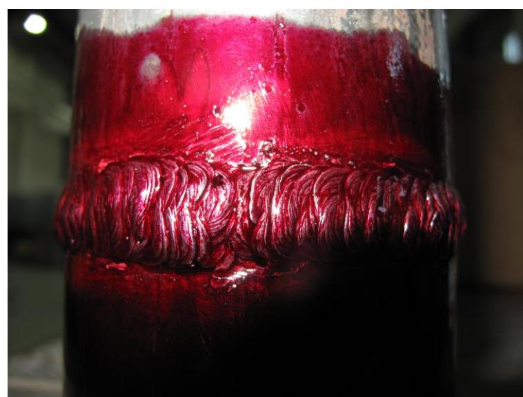
Slika 32. Uvećani prikaz nanešenog penetranta na površinu zavara
