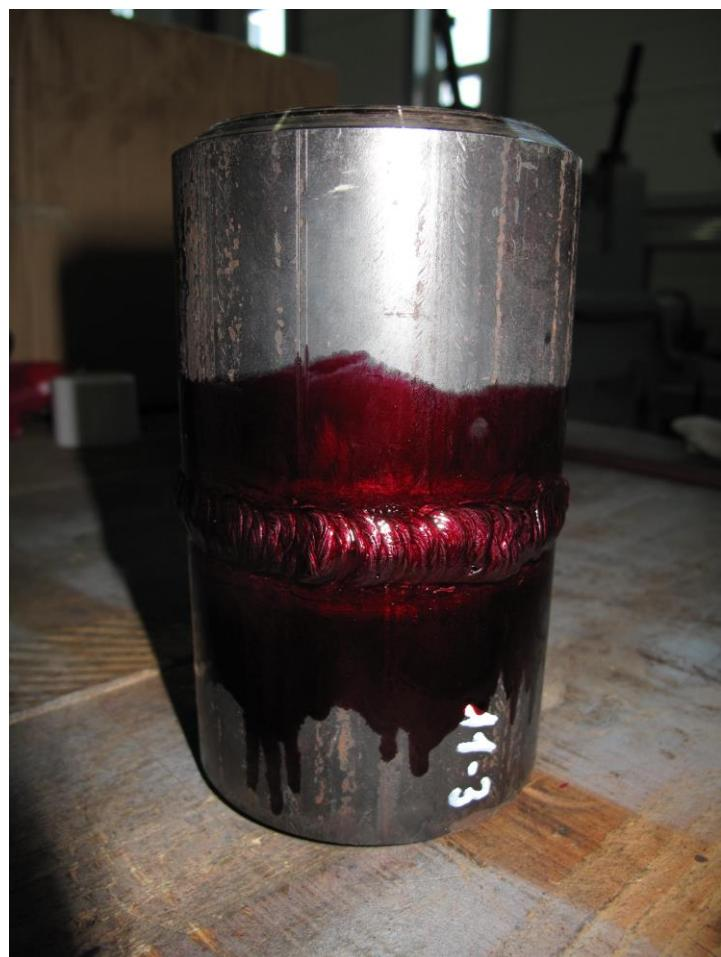
Slika 31. Prikaz nanešenog penetranta na površinu zavara
