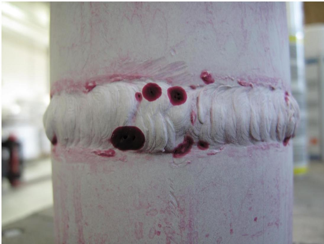
**Slika 34. Detektiranje penetrantskih indikacija**
