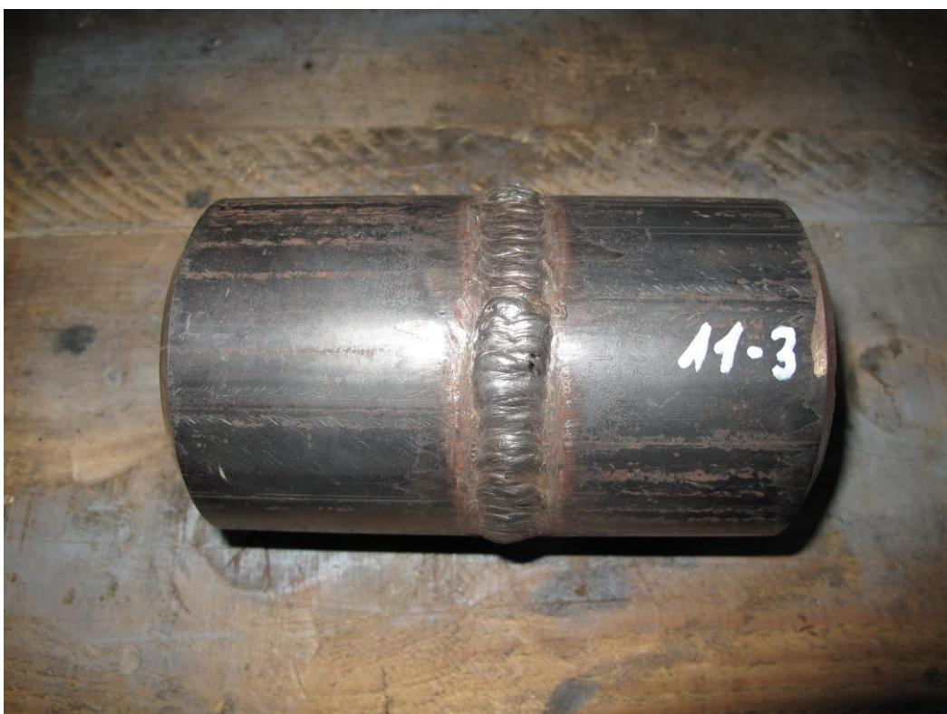
Slika 30. Čista površina pripremljena za nanošenje penetranta
