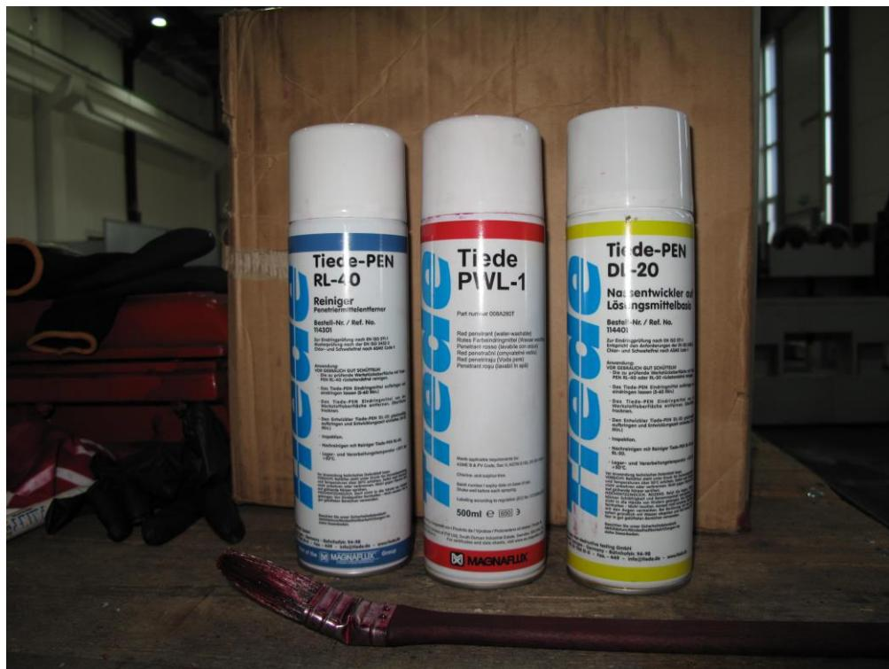
Slika 29. Oprema za provođenje ispitivanja
