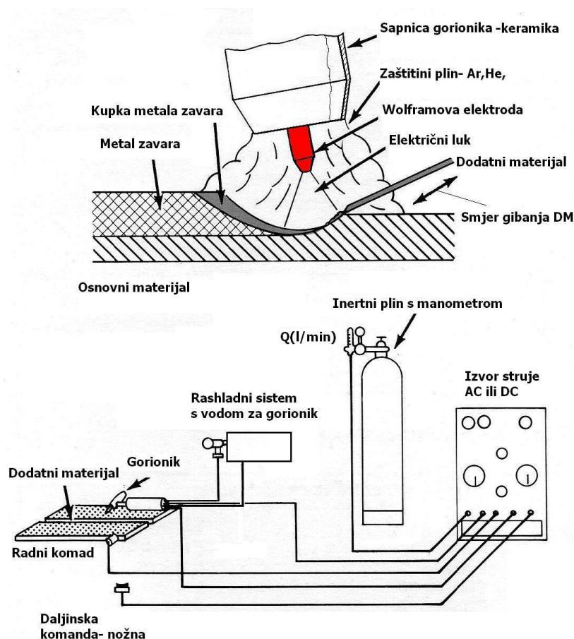
Slika 3. Shematski prikaz procesa i uređaja za TIG zavarivanje [10]
