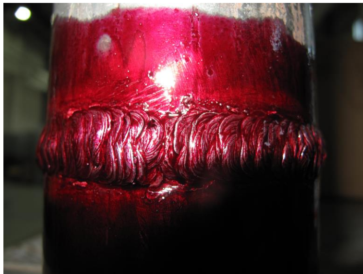
Slika 32. Uvećani prikaz nanešenog penetranta na površinu zavora
