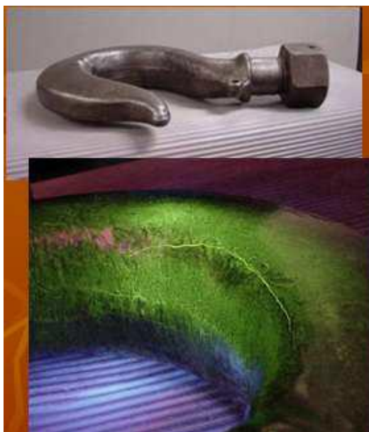
Slika 13. Indikacija pukotine primjenom magnetskih čestica [3]
