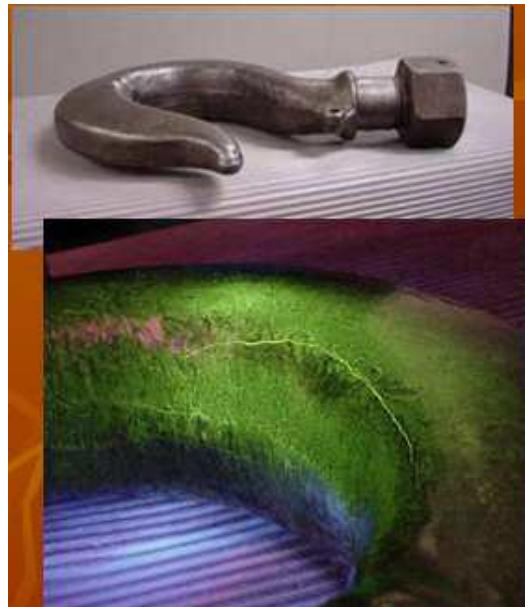
Slika 13. Indikacija pukotine primjenom magnetskih čestica [3]
