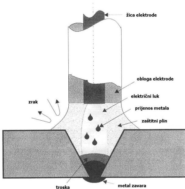
Slika 2. Shematski prikaz REL postupka zavarivanja [10]
