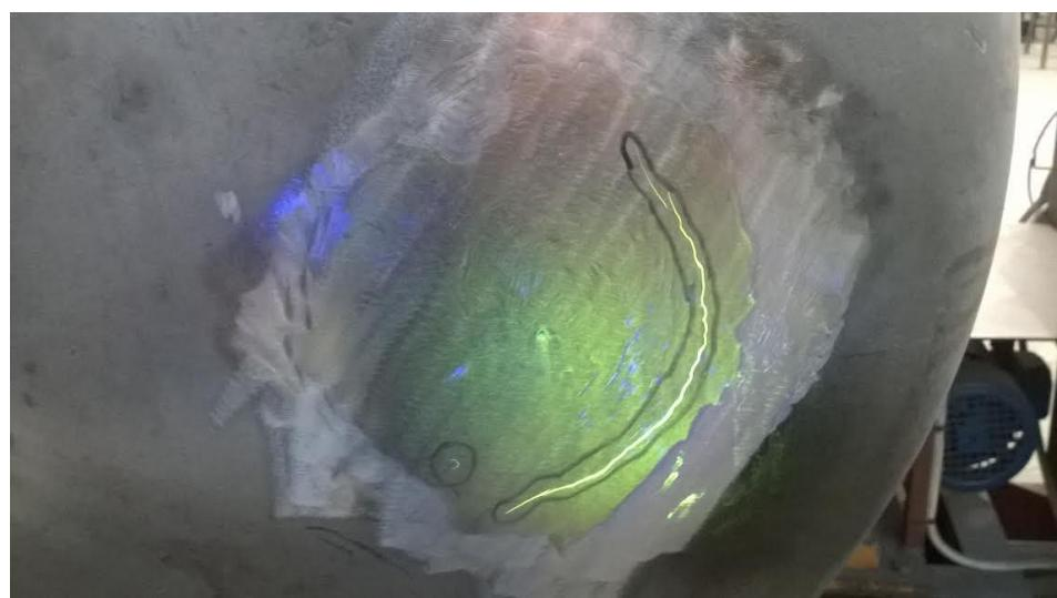
Slika 15. Indikacija pukotine primjenom magnetskih čestica [11]
