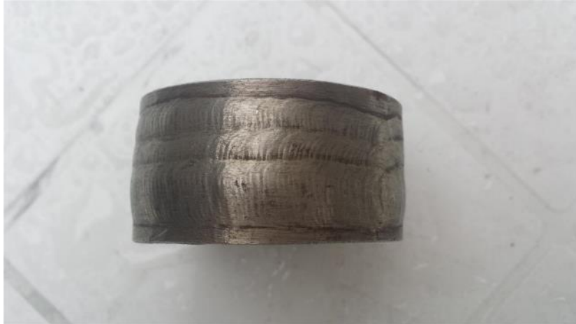
Slika 11. Pregled zavarenog spoja Vizualnom kontrolom [11]
