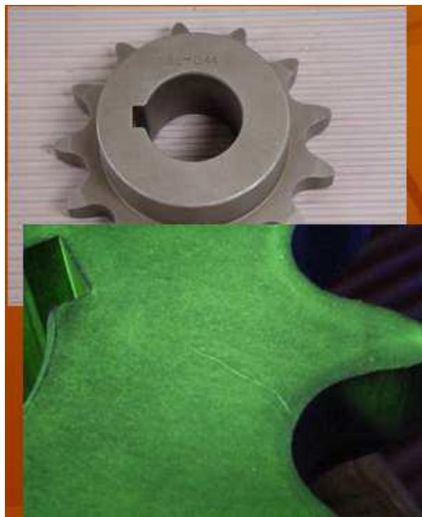
Slika 14. Indikacija pukotine primjenom magnetskih čestica [3]
