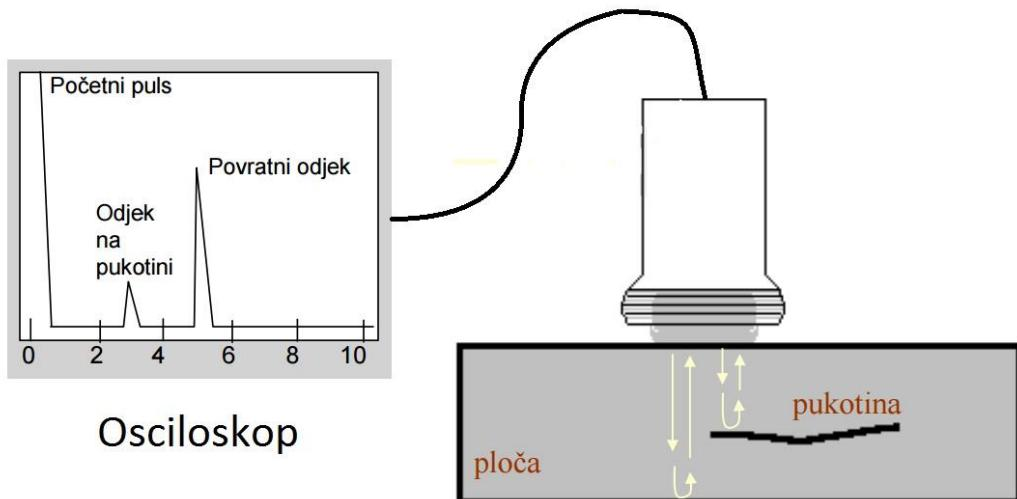
Slika 16. Ultrazvučno ispitivanje [3]
