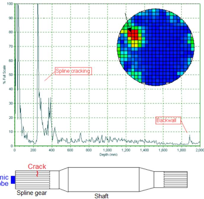
Slika 17. Ispitivanje vratila Ultrazvukom [4]
