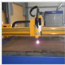
sl. 15. CNC rezanje plazmom
