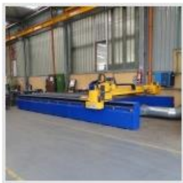
sl. 15. CNC rezanje plazmom
