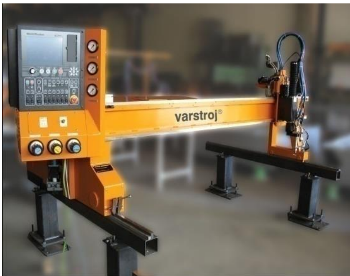
Slika 34 : CNC rezanje plazmom - Varstroj ( Lendava, SLO)
