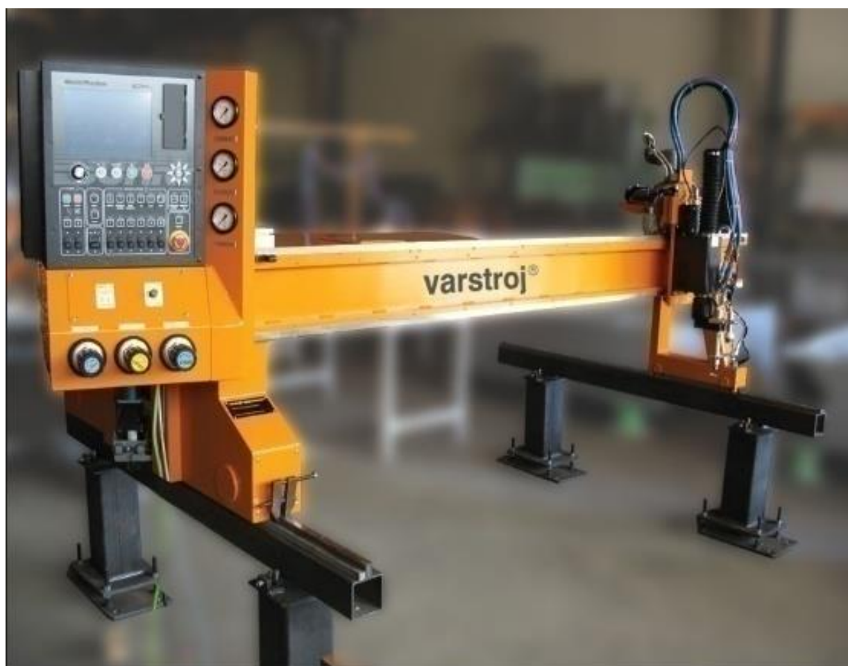
Slika 34 : CNC rezanje plazmom - Varstroj ( Lendava, SLO)
