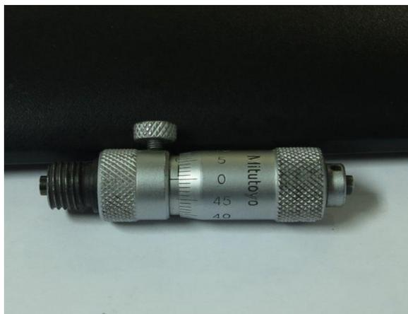
Slika 2.24. Štapni mikrometar dužine 50,00mm
