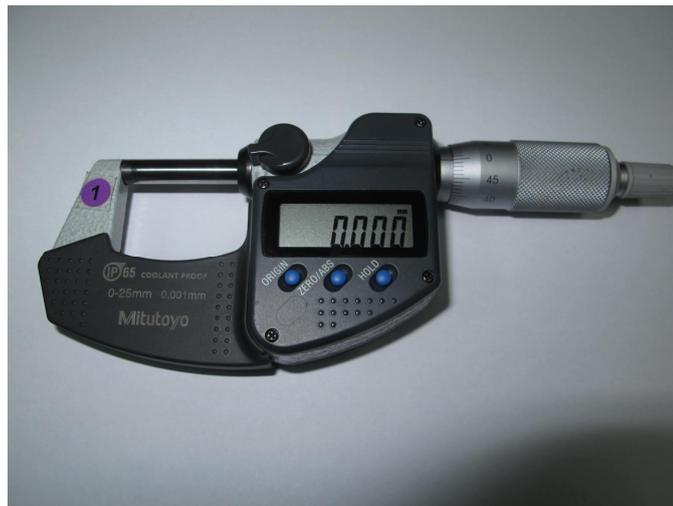
Slika 2.12. Digitalni obuhvatni mikrometar vrijednost 0,000mm
