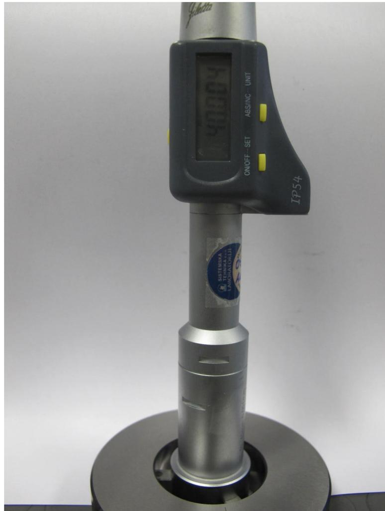
Sl.2.31. Trokraki digitalni mikrometar ; vrijednost 40,004mm
