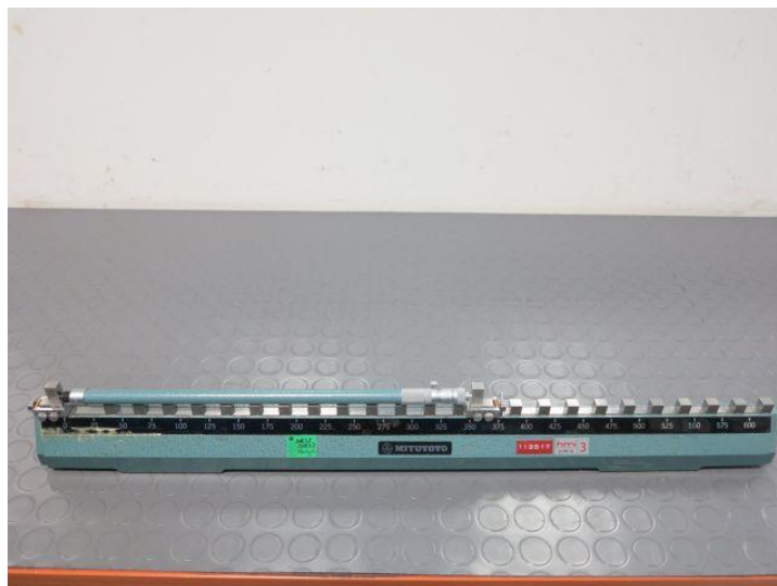
Slika 2.20 Umjeravanje štapnog mikrometra
