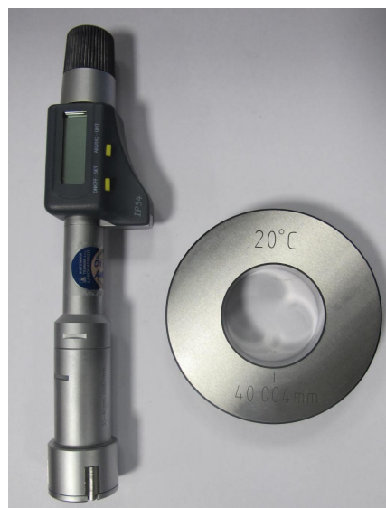
Sl.2.30. Trokraki digitalni mikrometar i prsten za kalibriranje
