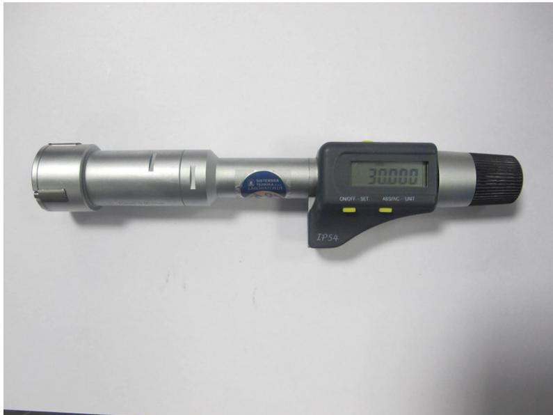
Sl. 2.32. Trokraki digitalni mikrometar ; vrijednost 30,000mm
