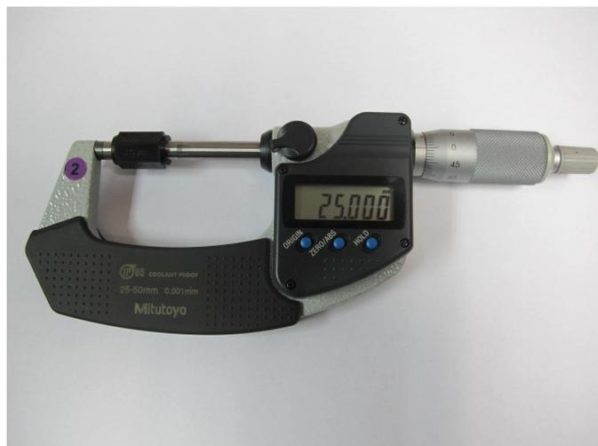
Slika 2.13. Digitalni obuhvatni mikrometar vrijednost 25,000mm
