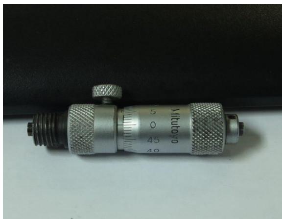
Slika 2.24. Štapni mikrometar dužine 50,00mm
