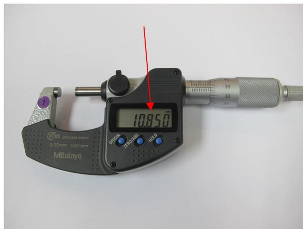
Slika 2.14. Digitalni obuhvatni mikrometar vrijednost 10,850mm
