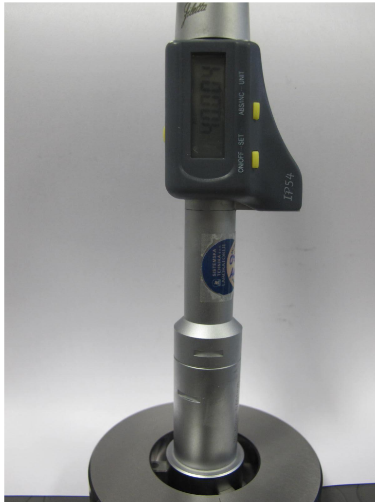
Sl.2.31. Trokraki digitalni mikrometar ; vrijednost 40,004mm
