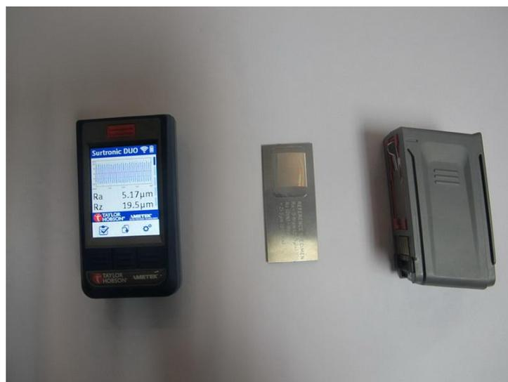
Sl. 2.38. Uređaj za mjerenje hrapavosti sa etalonom za umjeravanje
