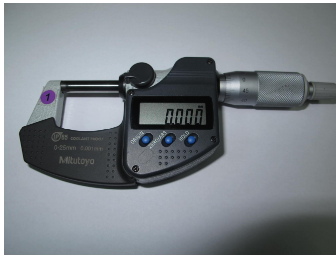
Slika 2.12. Digitalni obuhvatni mikrometar vrijednost 0,000mm
