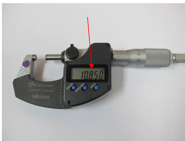
Slika 2.14. Digitalni obuhvatni mikrometar vrijednost 10,850mm
