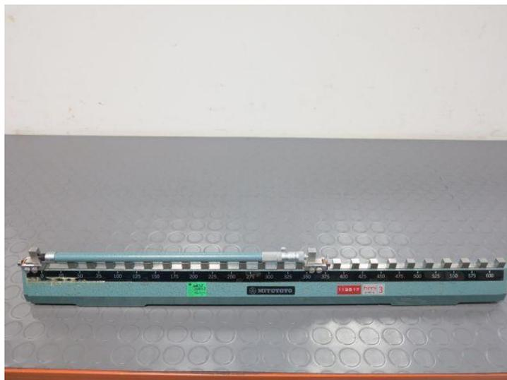
Slika 2.20 Umjeravanje štapnog mikrometra
