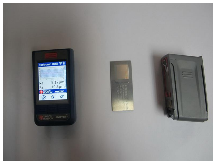
Sl. 2.38. Uređaj za mjerenje hrapavosti sa etalom za umjeravanje
