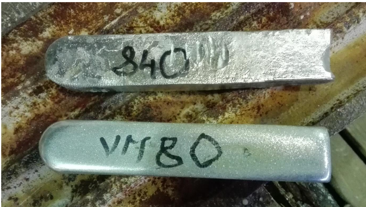
Slika 8. Odljevci bijele kovine (TEGOTENAX V840, WM 80)
