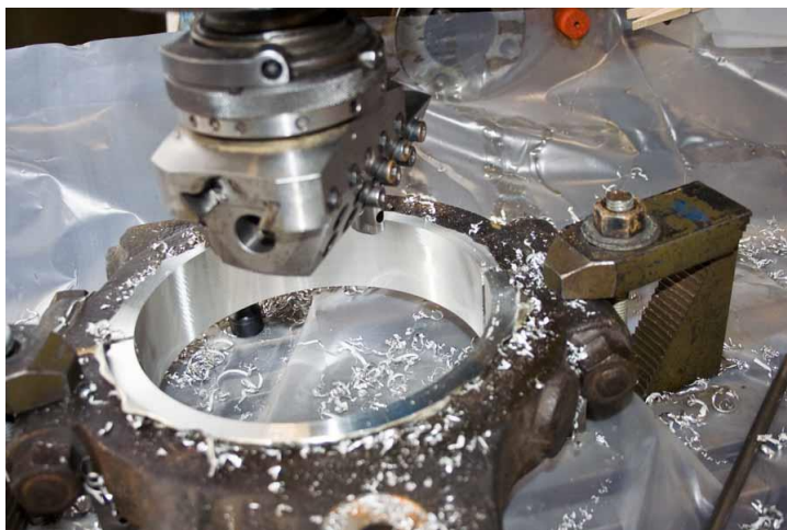
Slika 5. Prikaz sakupljanja strugotine na glodalici
