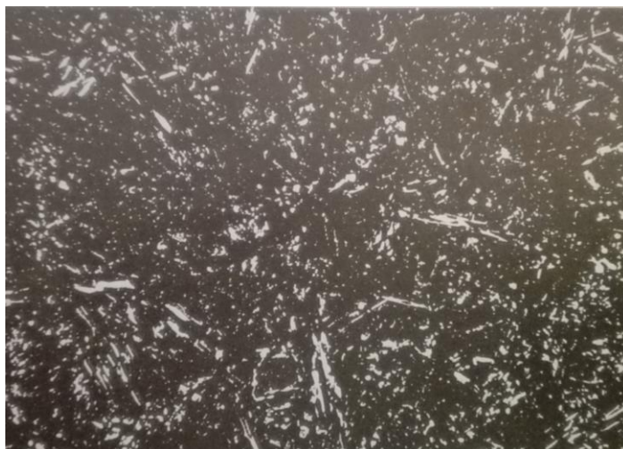
Slika 9. Mikrostruktura TEGOTENAX V840 [2]
