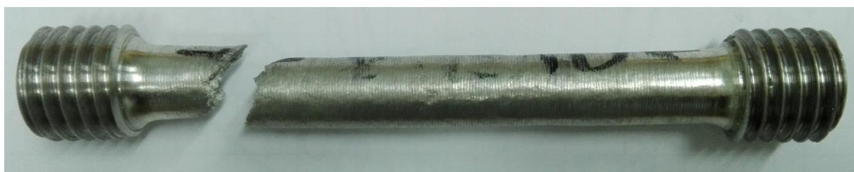
Slika 21. Lom epruvete TEGOTENAX V840 (prva strugotina)
