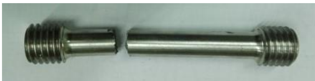
Slika 25. Lom epruvete WM 80 (druga strugotina)
