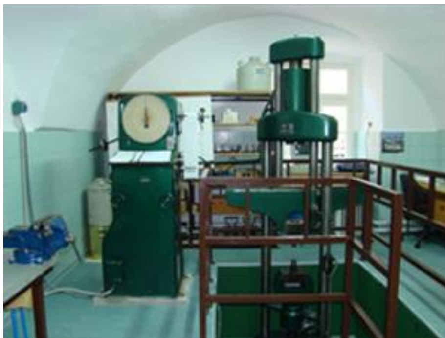
Slika 12. Kidalica Otto Wolpert Werke [6]
