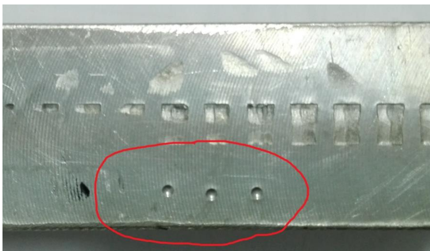
Slika 13. Uzorak za ispitivanje tvrdoće
