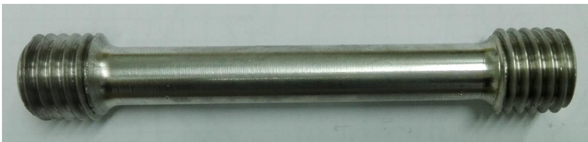
Slika 15. Epruveta TEGOTENAX V840
