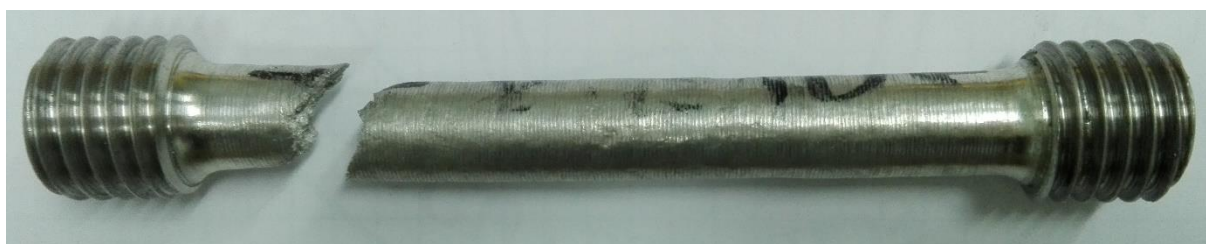
Slika 21. Lom epruvete TEGOTENAX V840 (prva strugotina)
