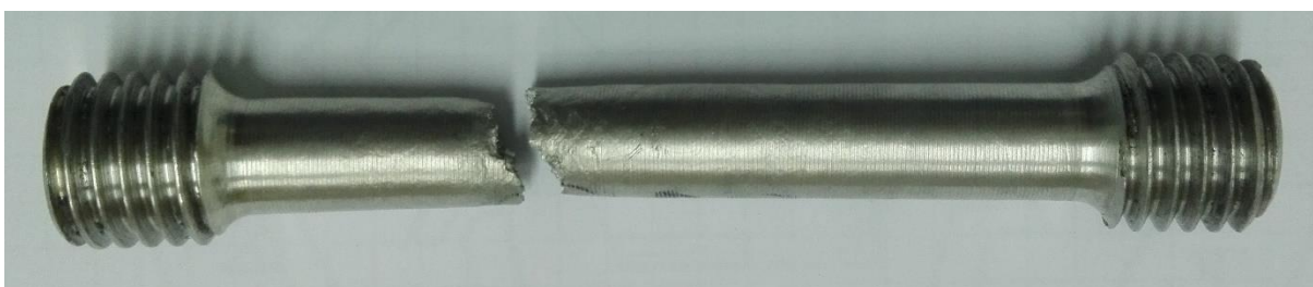
Slika 18. Lom epruvete TEGOTENAX V840 (nulta strugotina)
