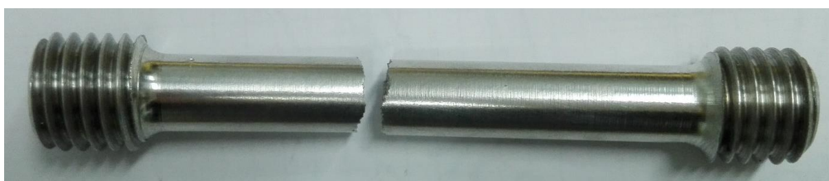
Slika 22. Lom epruvete WM 80 (prva strugotina)
