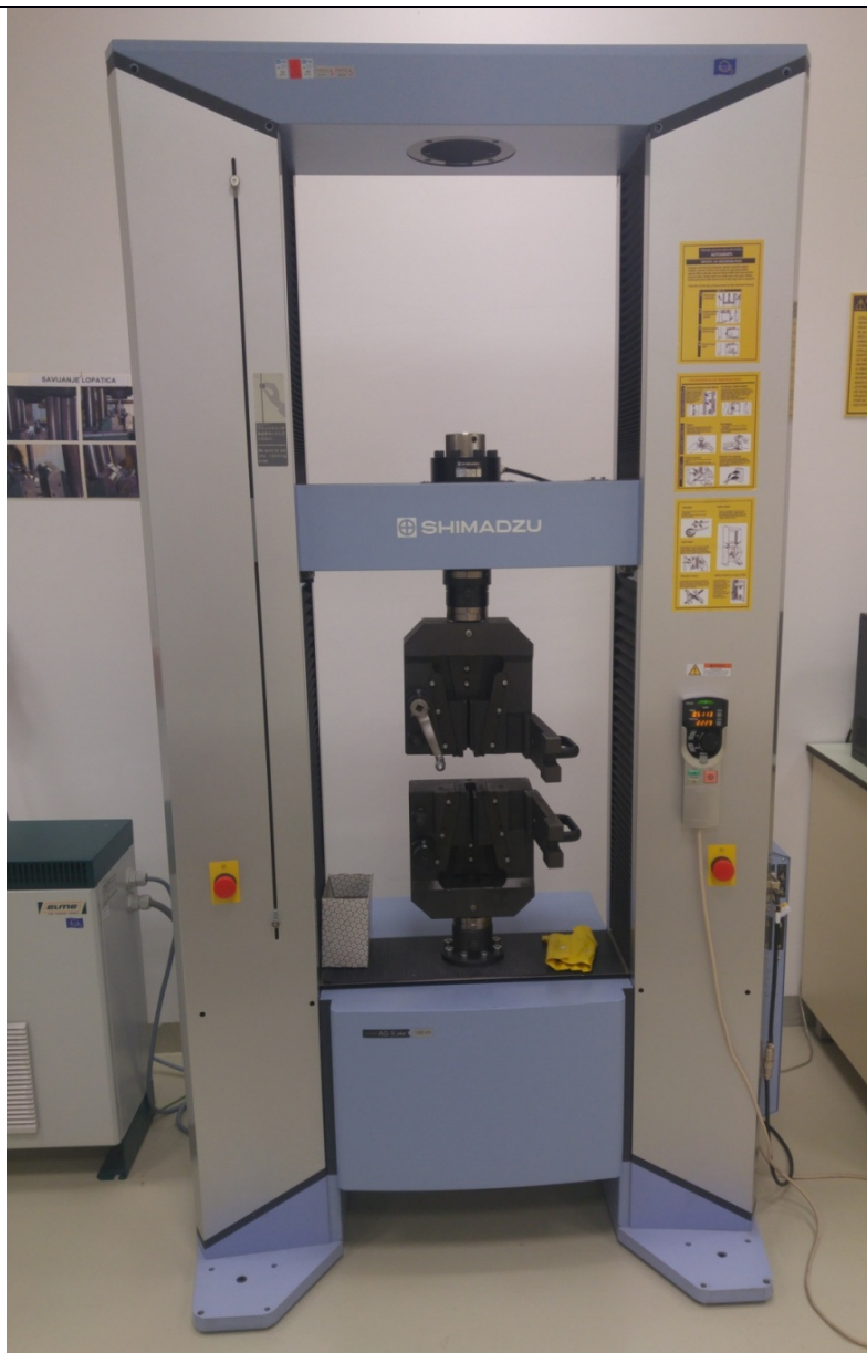
Slika 3.15. Kidalica na kojoj je odrađeno ispitivanje materijala
