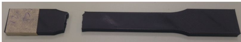
Slika 3.21. Model epruvete od PLA polimera sa dodatkom željeza sa magnetičnim svojstvima
