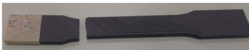
Slika 3.20. Model epruvete od PLA polimera sa dodatkom nehrđajućeg čelika
