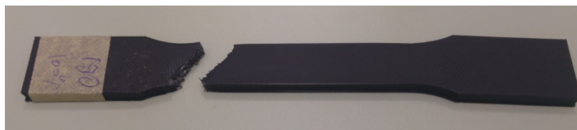
Slika 3.19. Model epruvete izrađen od običnog PLA polimera
