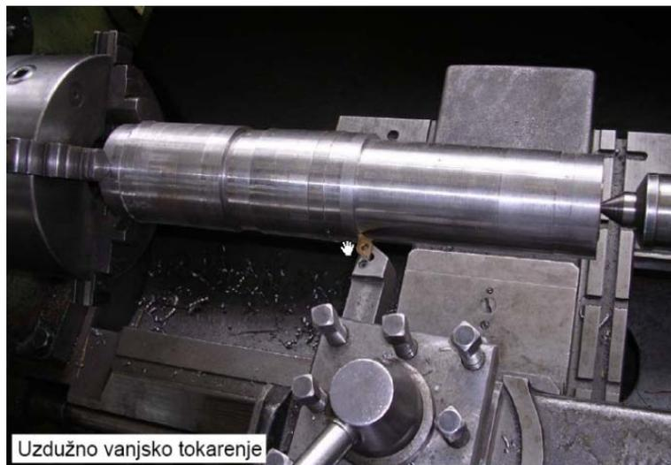
Slika 3. Uzdužno vanjsko tokarenje
