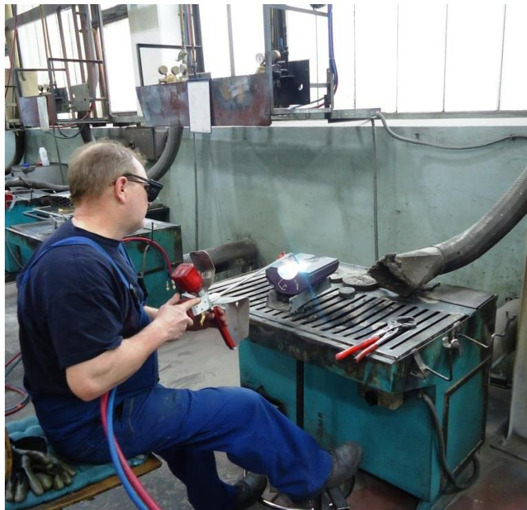
*Slika 26. Ručno navarivanje kalupa*
