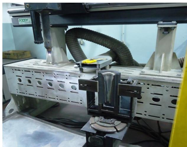
*Slika 27. Zavarivanje robotom*
