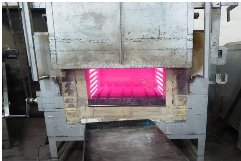
*Slika 25. Predgrijavanje u komornoj peći*
