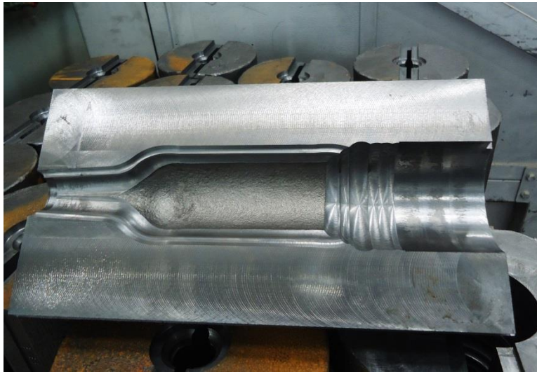
Slika 24. Glodanje prije metalizacije
