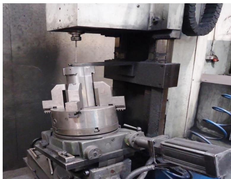
*Slika 38. Bušenje vakuum rupa*
