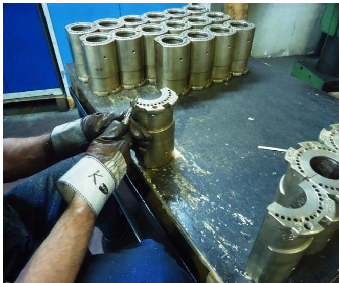
*Slika 39. Ručna obrada*
