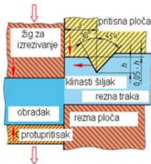
Slika 35. Primjer djelovanja šiljka i protupritisne ploče
