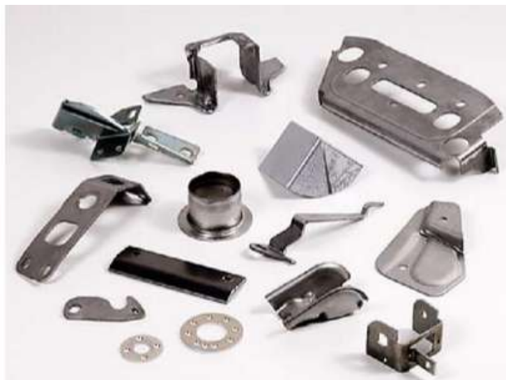
Slika 2. Primjeri štancanih proizvoda[5]
