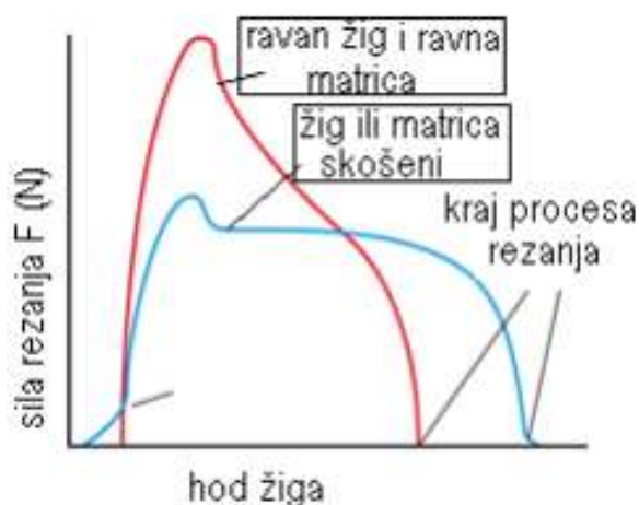
Slika 86. Utjecaj skošenja na silu rezanja [6]
