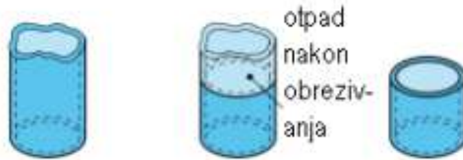
Slika 13. Skica obrezivanja izratka[5]
