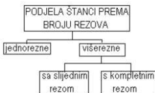
Slika 16. Podjela štanci prema broju rezova
