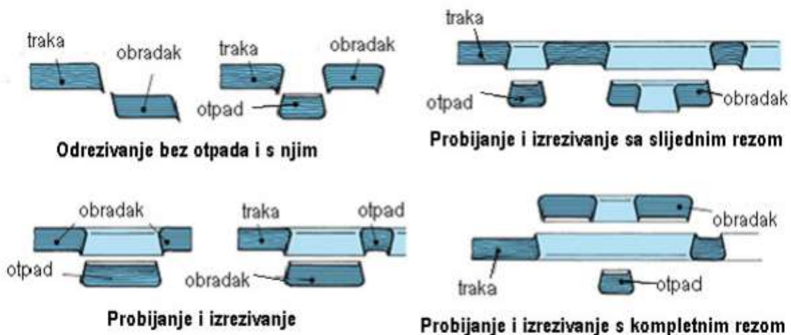
Slika 82. Položaj srha ovisno o postupku rezanja[5]
