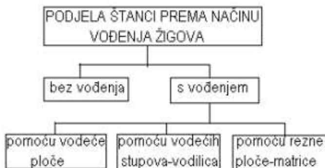
Slika 17. Podjela štanci prema načinu voženja žiga
