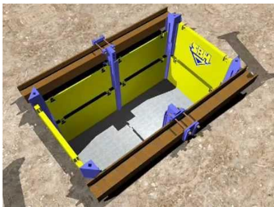
Slika 3 Zaštita bočnih strana prilikom iskopa [ http://sogradi.hr/wp-content/uploads/2016/02/Analiza-stanja-za%C5%A1tite-na-radu-u-sektoru-gra%C4%91evinarstva.pdf ]
