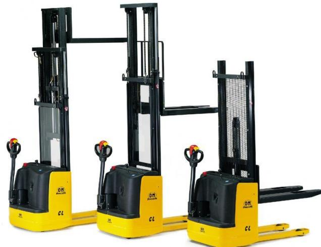
Slika 2. Ručno vođeni elektroviličari za visoko podizanje
