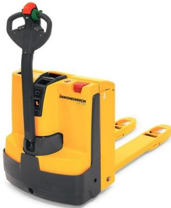
Slika 1. Ručno vođeni elektroviličar za nisko podizanje
