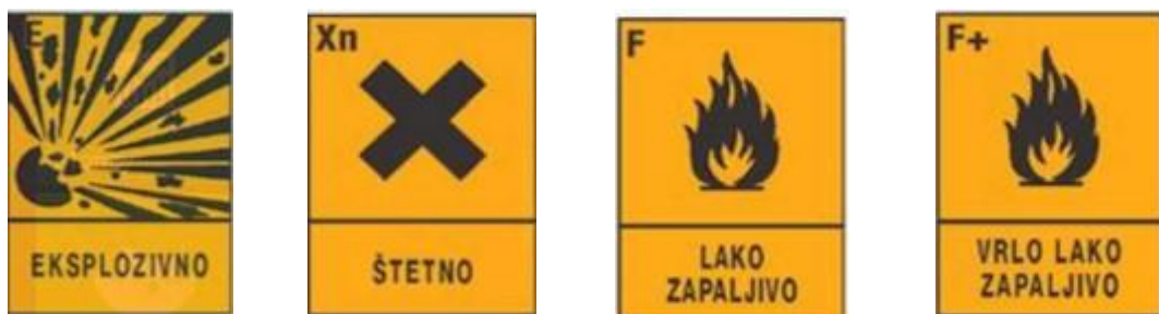
Slika 2 – Oznake koje nosi ukapljeni plin
