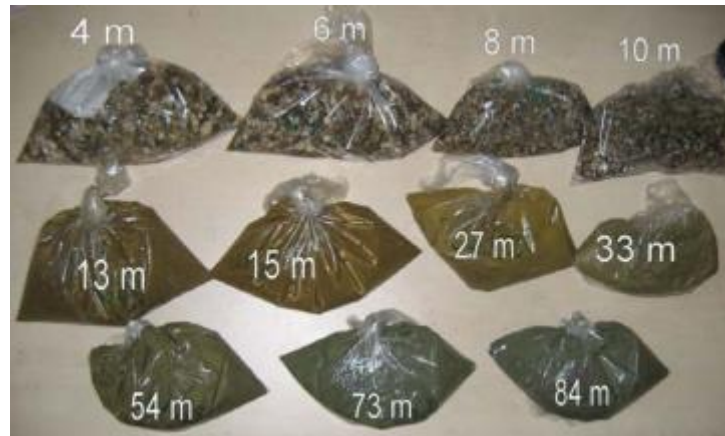
Slika 35. Uzorci tla po visini bušotine.
