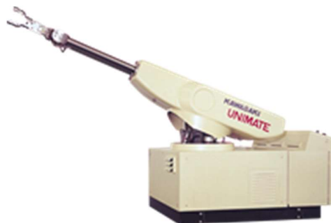
Slika 2. Prvi industrijski robot Unimate
