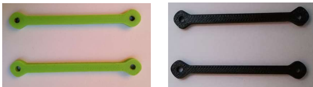
Slika 23. PLA spojnice prije i poslije bojanja crnom akrilnom bojom
