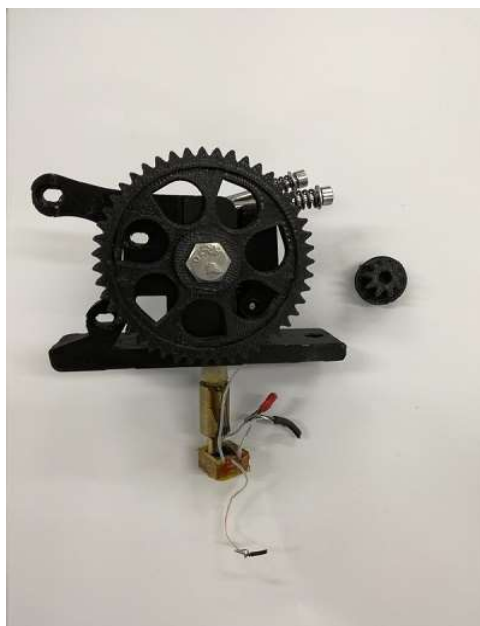
Slika 17. Neispravan mehanizam ekstrudera s mlaznicom
