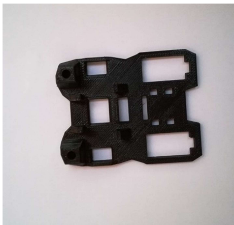
Slika 21. Gotovi dijelovi isprintani PETG materijalom
