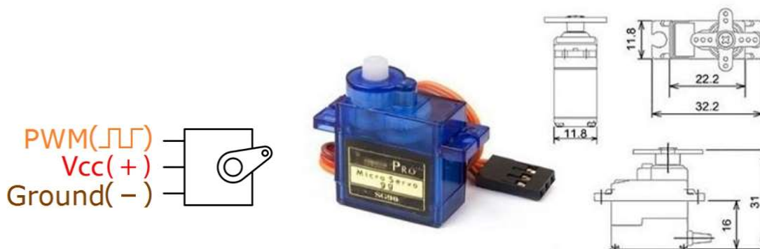
Slika 27. Tower Pro SG90 9g servo motor
