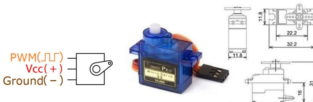
Slika 27. Tower Pro SG90 9g servo motor
