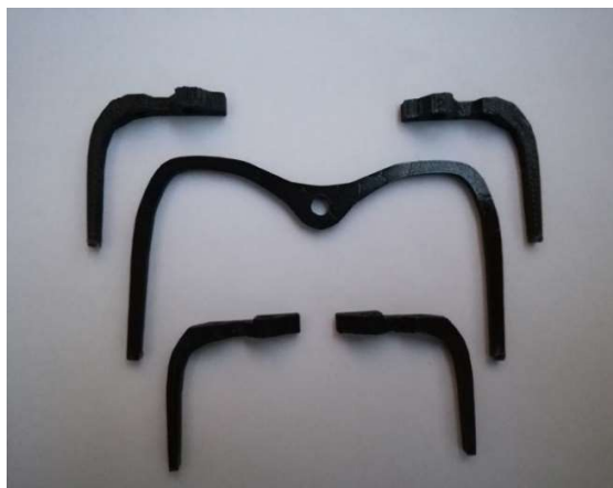
Slika 21. Gotovi dijelovi isprintani PETG materijalom
