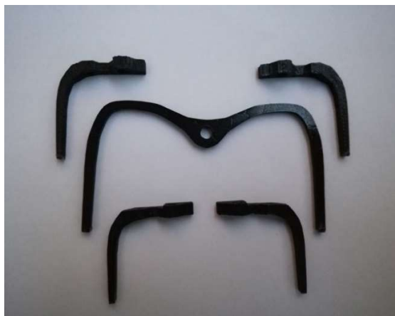
Slika 21. Gotovi dijelovi isprintani PETG materijalom
