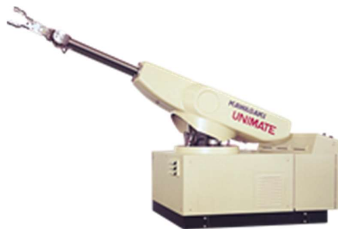
Slika 2. Prvi industrijski robot Unimate
