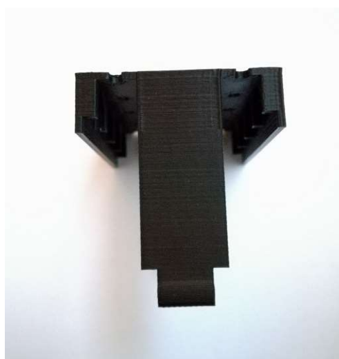
Slika 22. Gotovi dijelovi isprintani ABS materijalom
