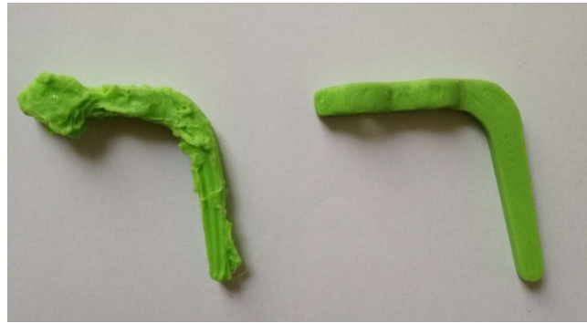
Slika 18. Noga hexapoda isprintana prije i poslije popravka 3D printera
