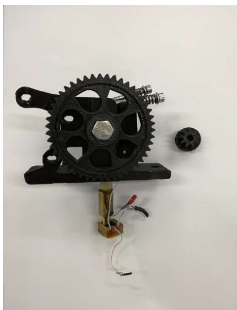
Slika 17. Neispravan mehanizam ekstrudera s mlaznicom
