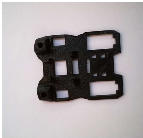
Slika 21. Gotovi dijelovi isprintani PETG materijalom
