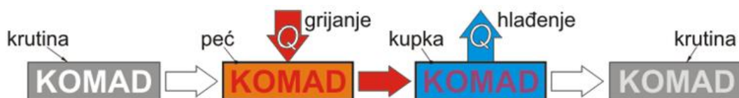
Slika 12. : Opći prikaz toplinske obrade [3]
