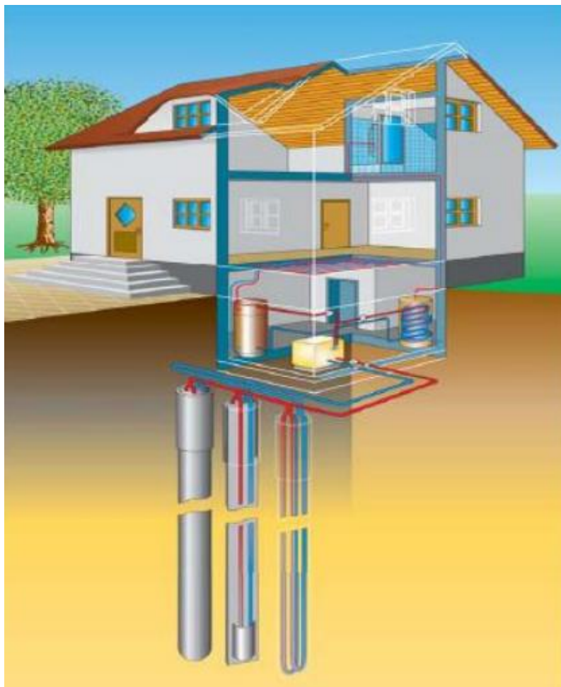
Slika 18. Shema podzemne toplinske sonde [5]
