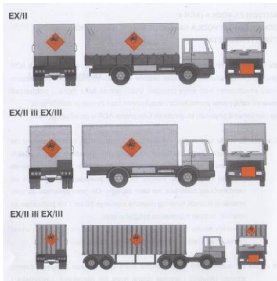
Slika 25: Vozila za prijevoz eksplozivnih tvari cestom (Izvor: [8])
