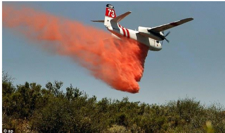
Slika 2. Nanošenje retardanta na vegetaciju iz zraka
