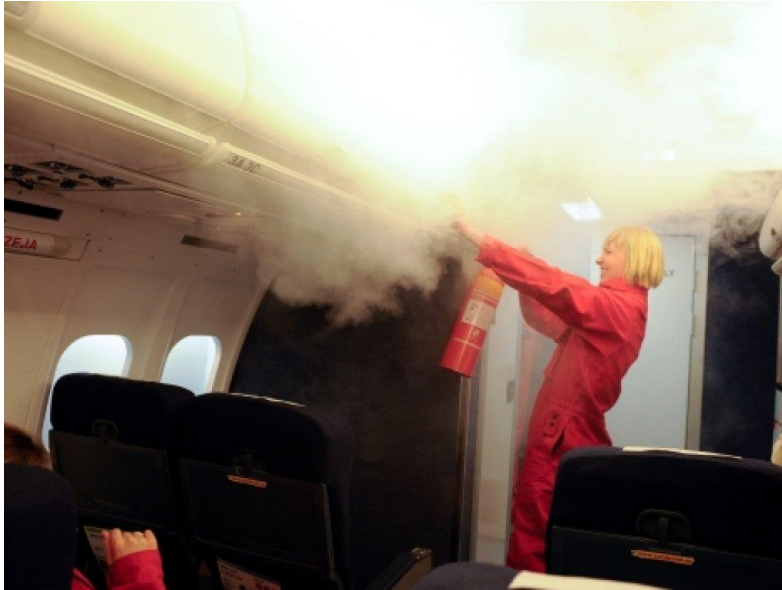
Slika 10. Primjena halona u zrakoplovu
