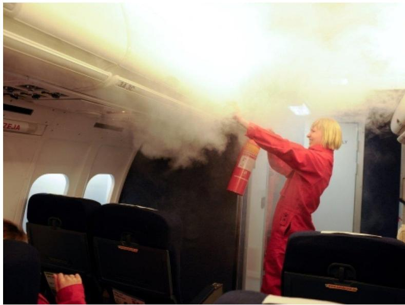
Slika 10. Primjena halona u zrakoplovu
