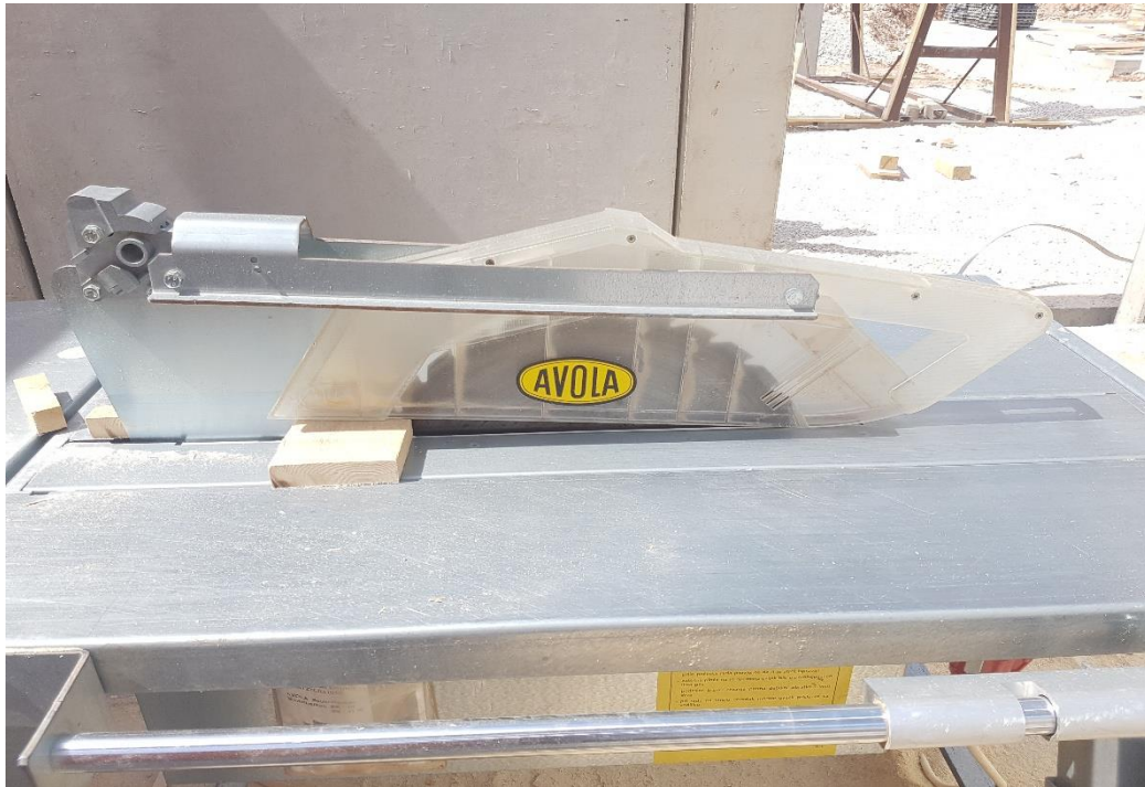
Sl. 2. Zaštitna naprava na kružnoj pili
