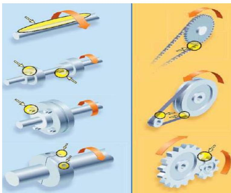
Sl.18. Mesta gdje može doći do ozljeda od pokretnih elemenata pogonskih mehanizama
