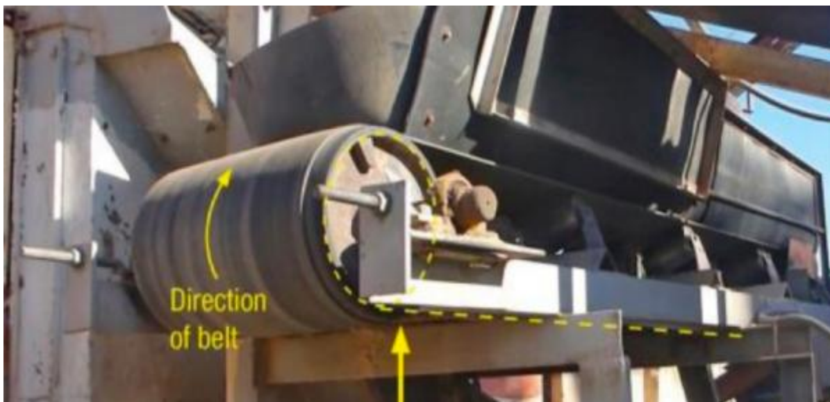
Sl. 19. Primjer trakastog transportera na kakvom je došlo do lakše ozljede
