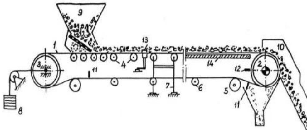
Sl. 2. Opći izgled i sastavni dijelovi trakastog transporterata
