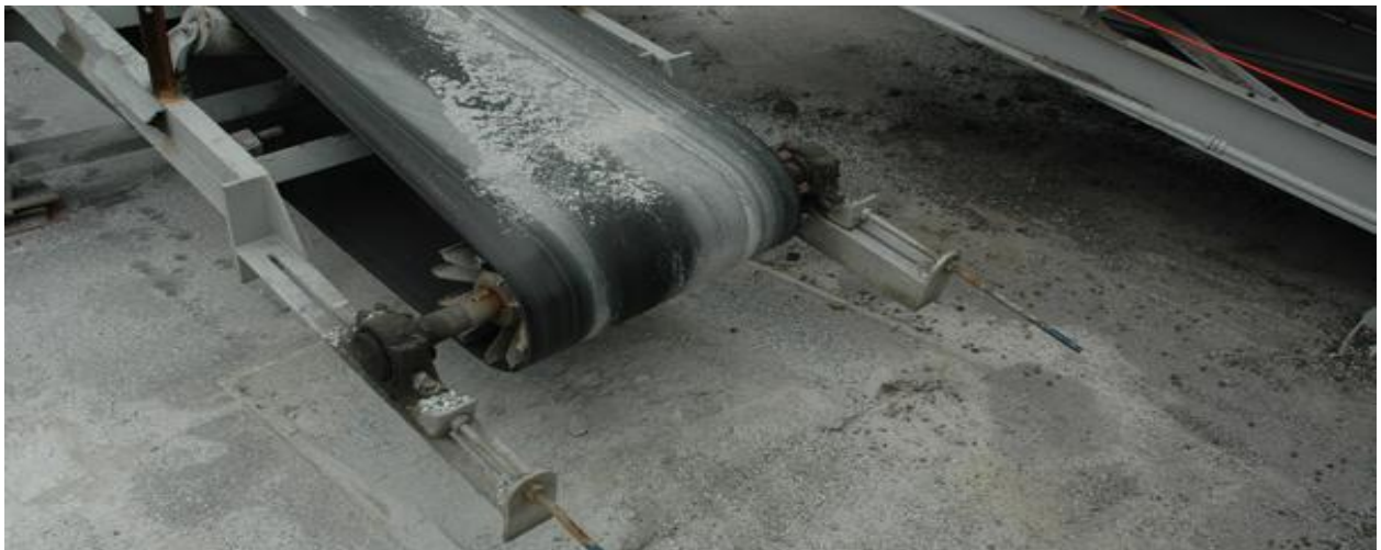
Sl.21. Primjer trakastog transportera na kakvom je došlo do ozljede sa smrtnim posljedicama
