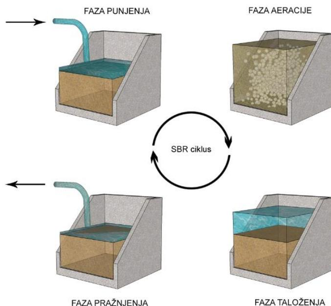
Slika 1. Ciklus obrade sekvencionalnog šaržnog reaktora [2]
