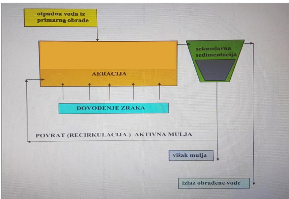
Slika 3. Shema procesa biološke obrade s aktivnim muljem [6]
