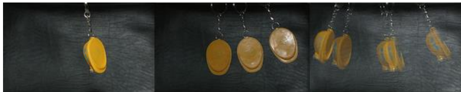
Sl. 8. Stroboskopski efekt
