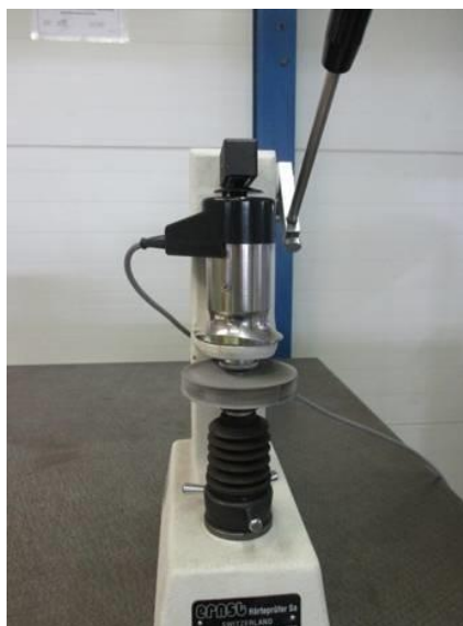
Slika 19. Primjer postavljanja uzorka na postolje mjernog uređaja
