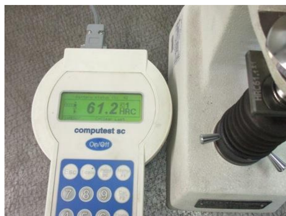
Slika 18. Interna provjera ispravnosti mjernog uređaja
