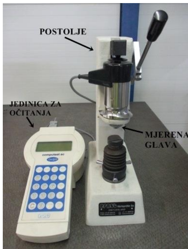
Slika 17. Dijelovi mjernog uređaja
