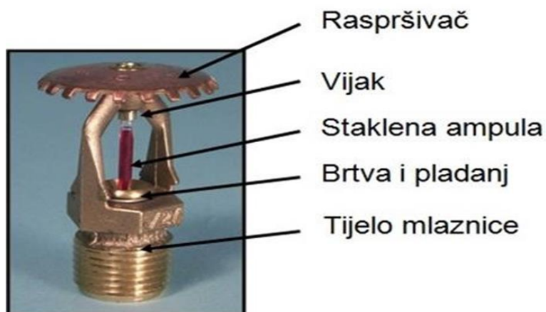
Slika 12. Osnovni dijelovi sprinkler mlaznice [1]
