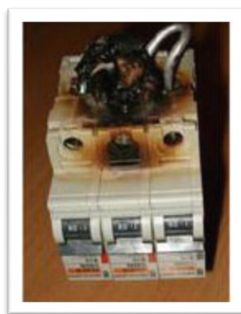
Slika 15: Prikaz spaljenog osigurača [14].
