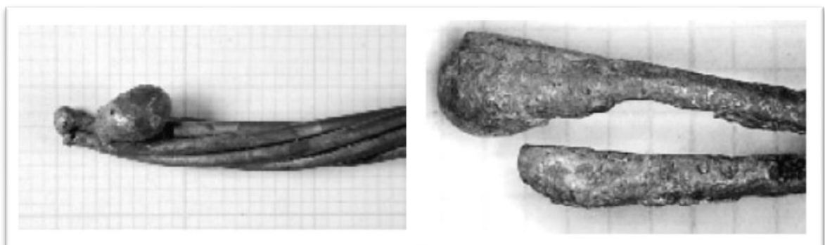
Slika 9: Prikaz kuglica nastalih kao posljedica požara [12].
