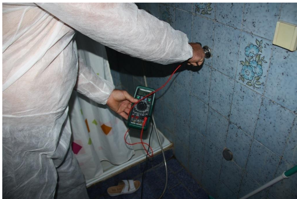
Slika 33: Ispitivanje električnih uređaja korištenjem digitalnog multimetra [20].
