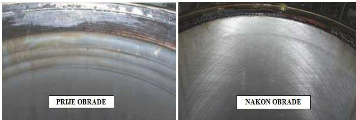
Slika 34. Površina košuljice cilindra prije i poslije honanja [23]
