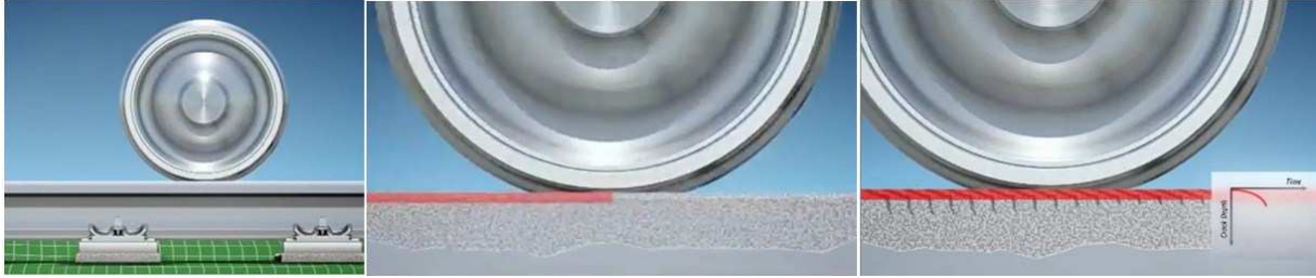
Slika 20. Pojava mikropukotina na željezničkim tračnicama [15]
