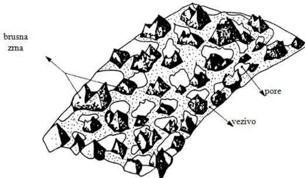
Slika 3. Rezna površina brusila [4]
