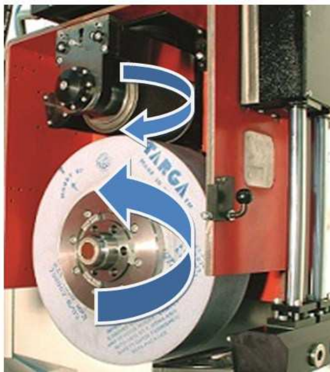
Slika 10. Sustav kontinuiranog profiliranja kod CDCF brušenja [12]
