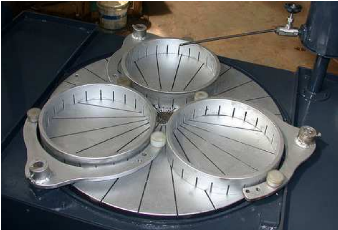
Slika 36. Ploča s gnijezdima za prihvat obradaka pri lepanju [21]
