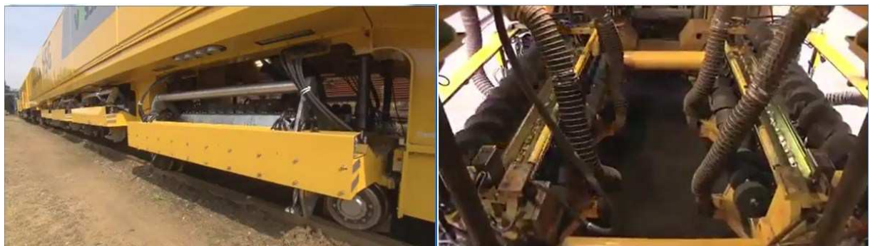
Slika 23. Izgled stroja za brušenje željezničkih tračnica [15]
