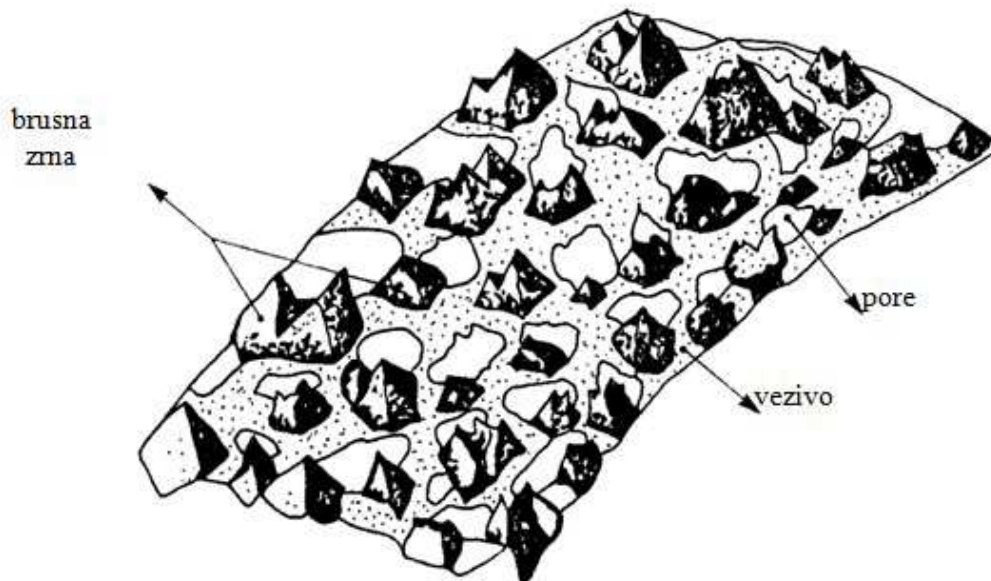
Slika 3. Rezna površina brusila [4]
