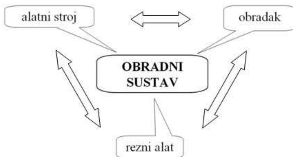
Slika 1. Osnovni elementi obradnog sustava [2]
