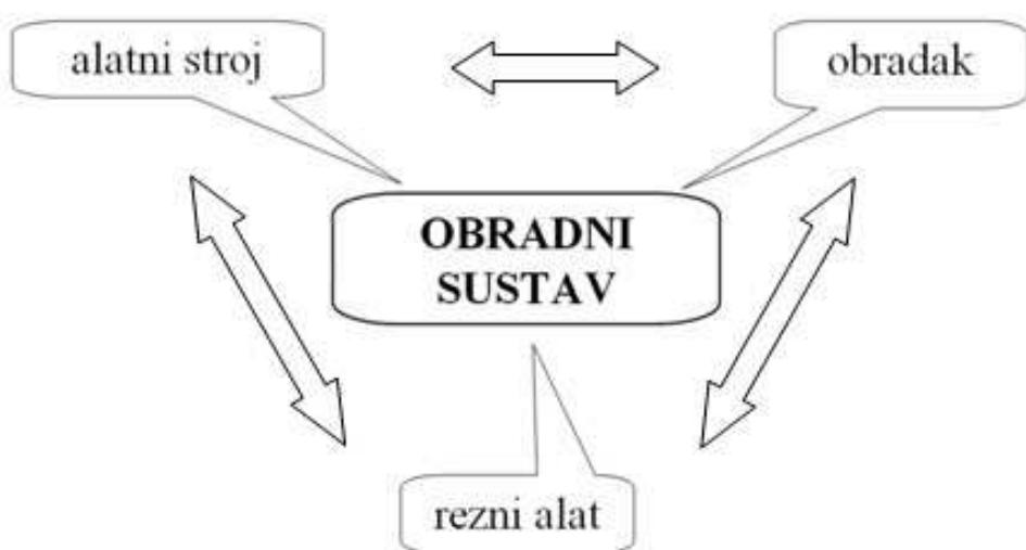
Slika 1. Osnovni elementi obradnog sustava [2]
