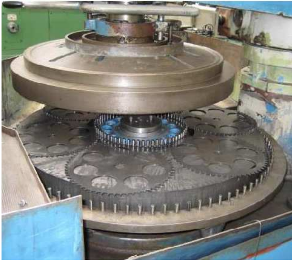
Slika 43. Stroj za lepanje sa šest gnijezda za obratke [21]
