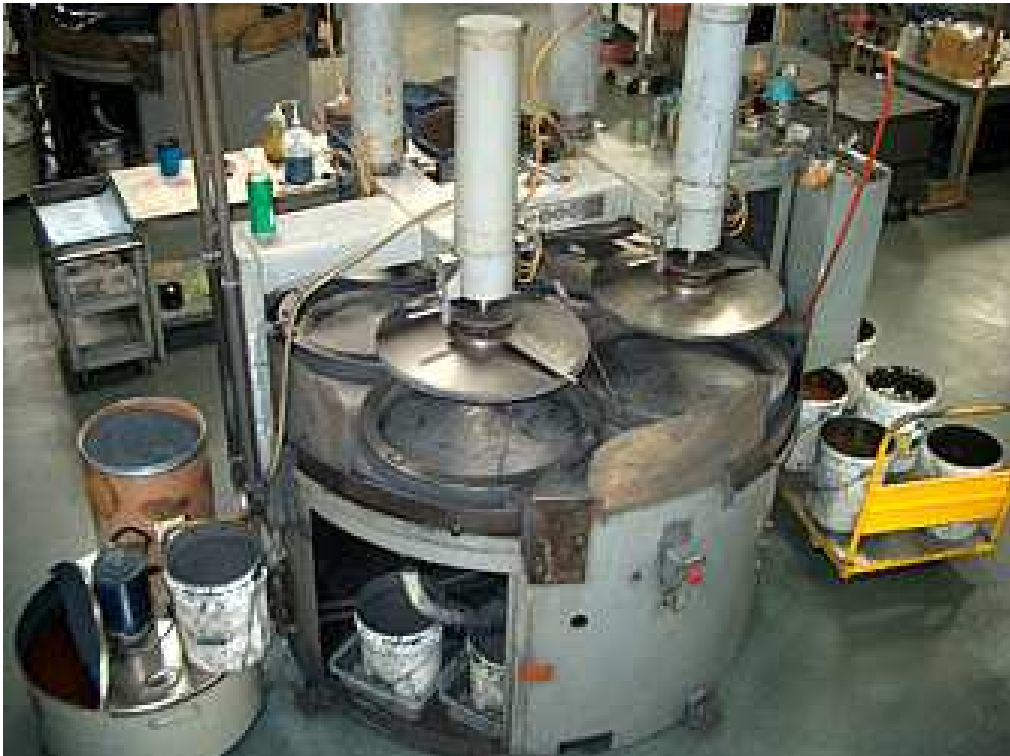
Slika 42. Stroj za lepanje s četiri gnijezda za obratke [21]
