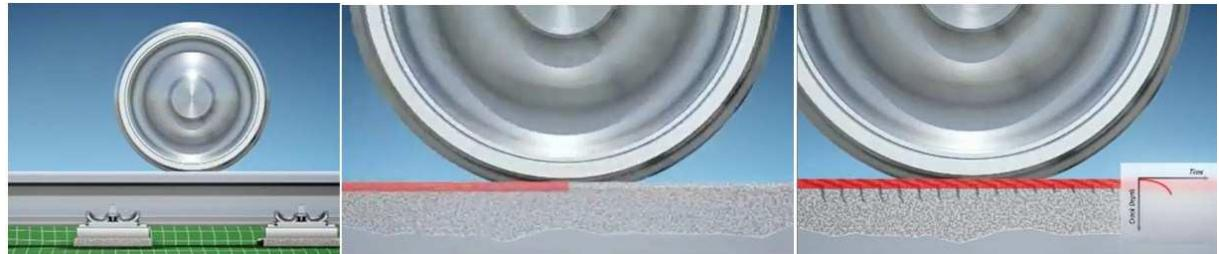
Slika 20. Pojava mikropukotina na željezničkim tračnicama [15]
