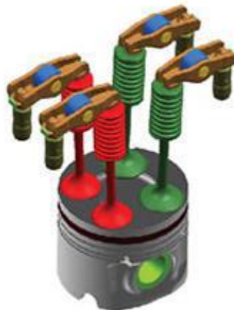
Slika 13 Viševentilska tehnika (4 ventila) [3]
