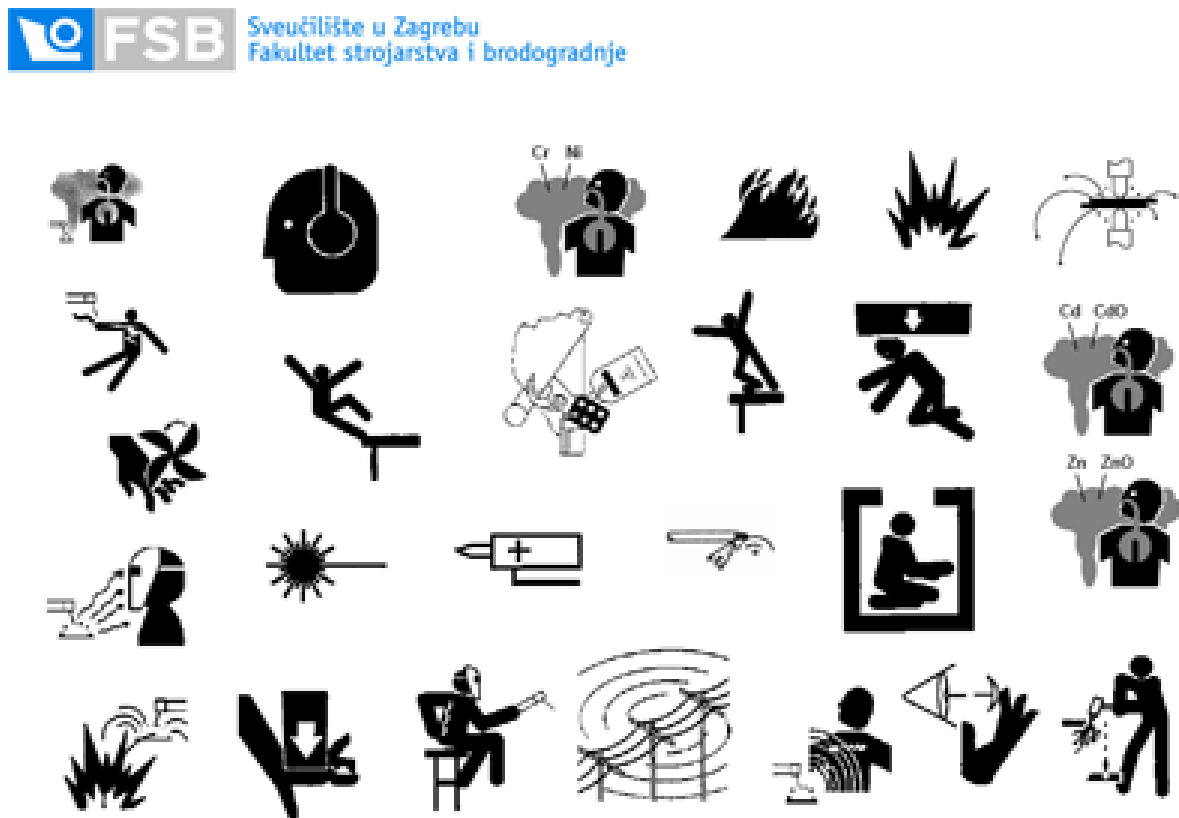
Slika 4. Mjere opreza kod ručnog zavarivanja
